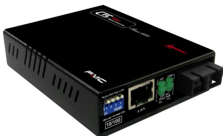
Figur 4: En brygga som används för att omvandla Ethernet till FDDI.
