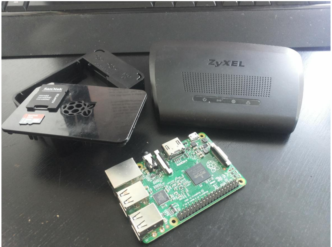
Raspberry Pi 2, ZyXel-reititin, MicroSD-muistikortti ja Pi:n suojakotelo
