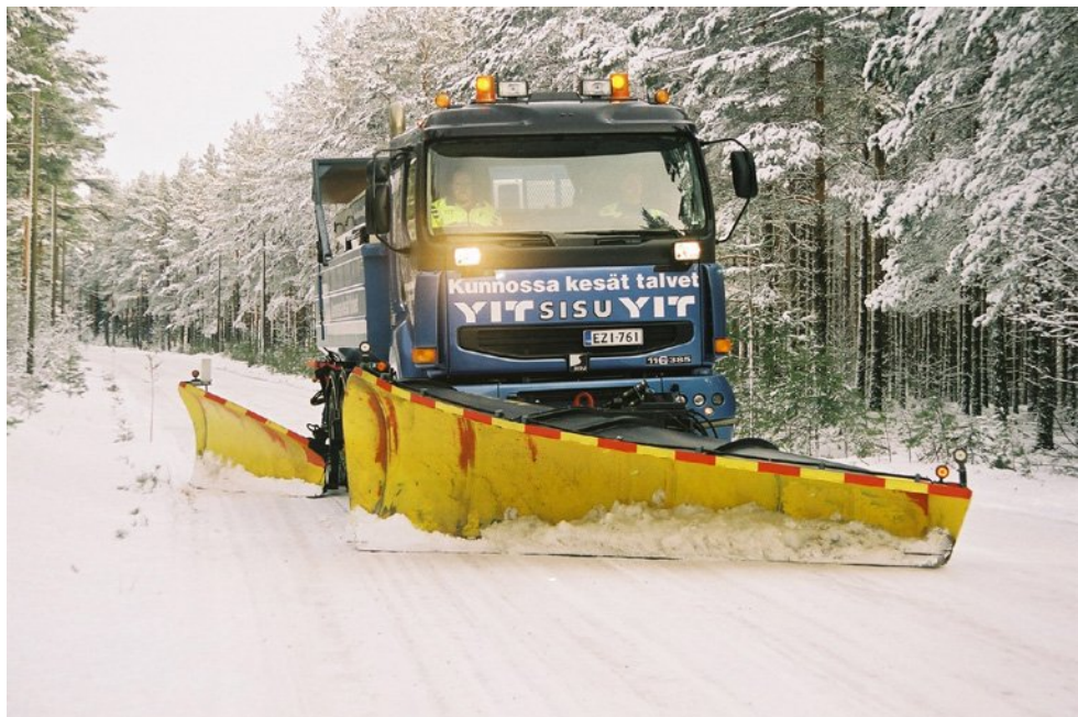
Kuva 3 Talvihoitotöihin kuuluvaa auraamista etu- ja sivuauralla varustetulla tienhoitoautolla.
