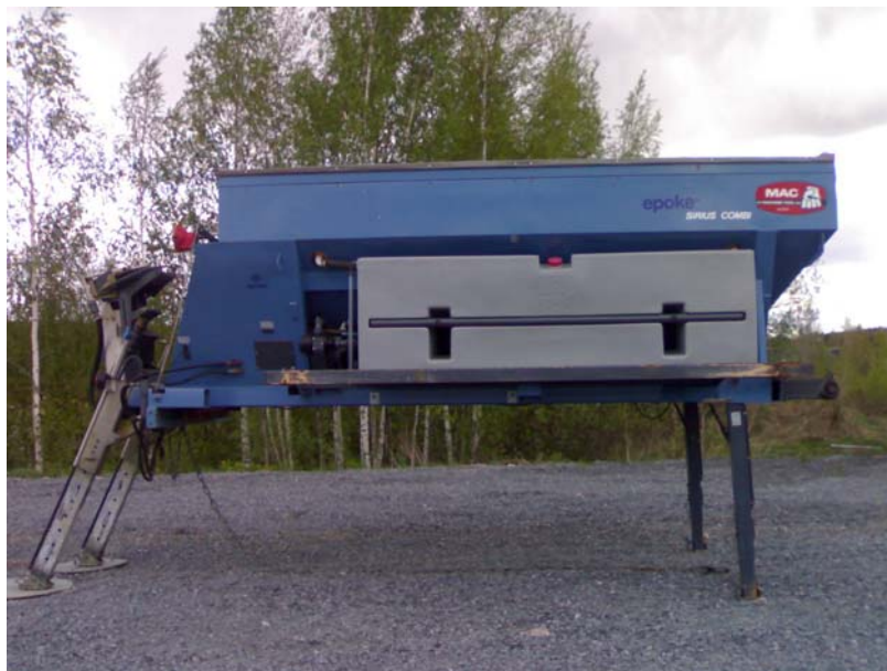
Kuva 6 Nykyiset suolauksetin on suunniteltu kuorma-autokäyttöön.
