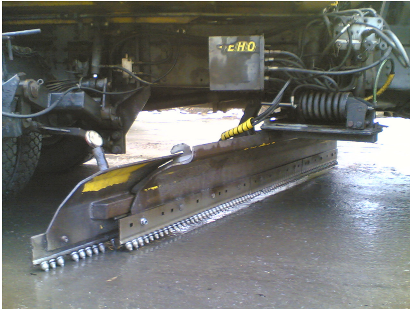
Kuva 10 Soratien pinnan muokkaus kuorma-auton alusterällä. /15/
