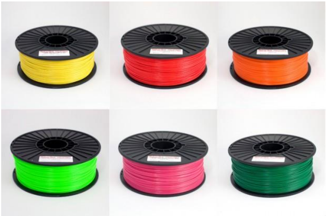
Kuva 6. Erivärisiä ABS-muovimateriaaleja kelalla FDM-tulostimelle [15].
