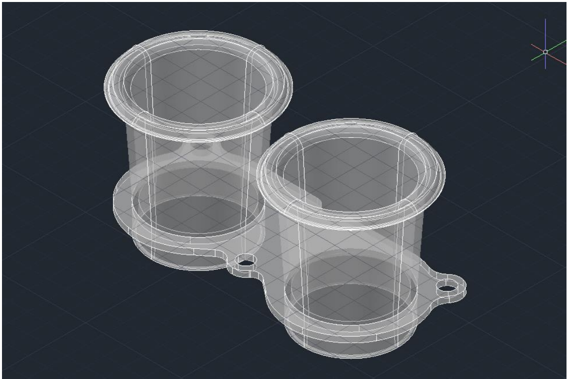
Kuva 15. 3D-malli läppärungon imutorvista AutoCAD 2015 -ohjelmassa.
