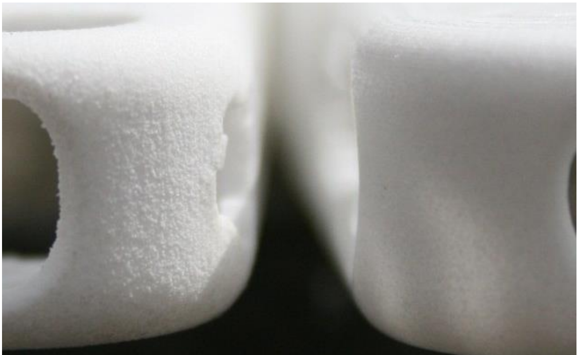
Kuva 7. SLS-menetelmällä tulostettu PA12-kappale ennen ja jälkeen kiillotuksen [16].
