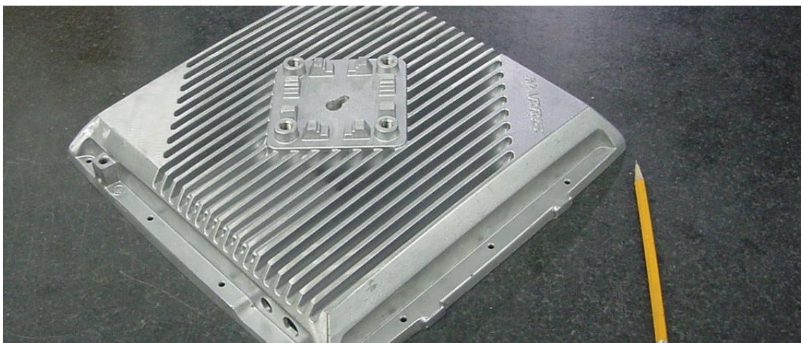
Kuva 9. DMLS-menetelmällä ruostumattomasta teräksestä valmistettu kappale [19].
