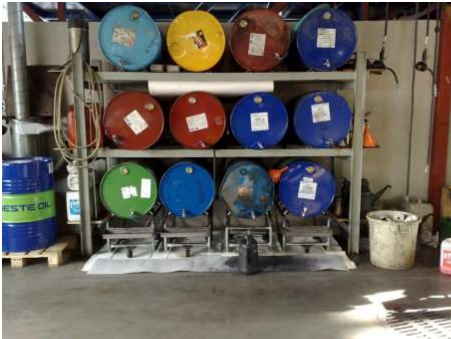
Kuva 4. Öljyjen varastointia puulavoilla ja varastohyllyssä ilman turva-allastusta.
