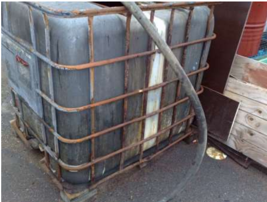
Kuva 6. Jäteöljyjä ulkoalueilla ilman turva-altaita.
