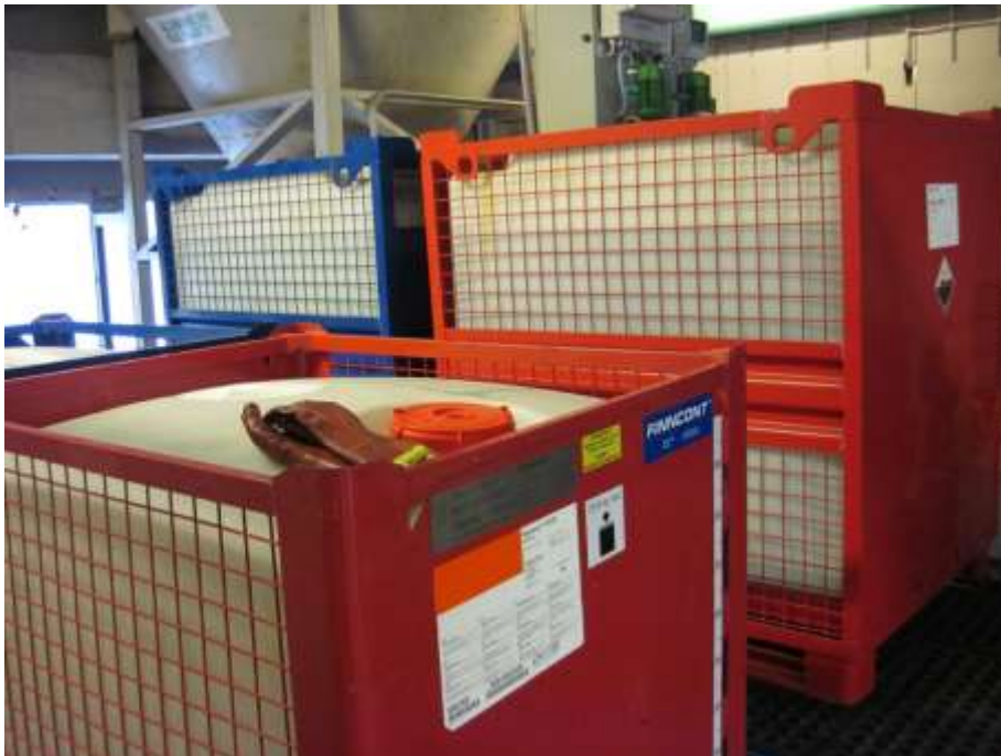
Kuva 8. Keskenään vaarallisesti reagoivia kemikaaleja IBC-konteissa ilman turva-altaita.
