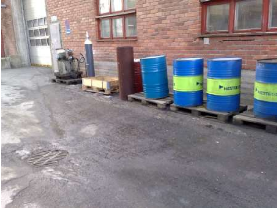
Kuva 3. Öljyjen varastointia ulkoalueilla. Sadevesikaivoon matkaa 3 metriä.
