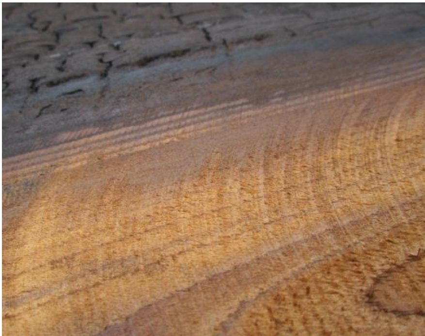
Kuva 19. Koekappale PALO 2 (Työstö jyrsimellä)
