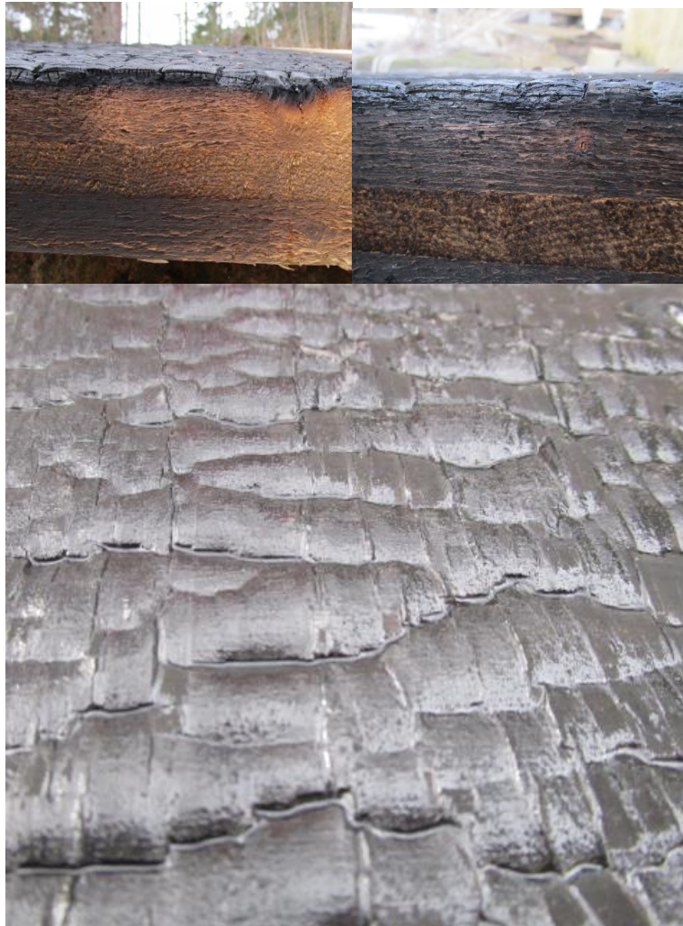
Kuva 10. Koekappaleet PALO 1 ja PALO 2 (hiiltymä n. 5-10 mm)
