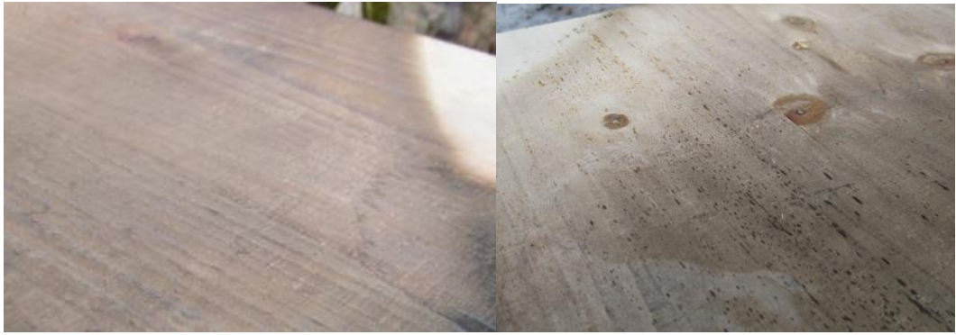
Kuva 16. Koekappaleet SAVU 2 ja SAVU 3 (Savuvauriota, ei hiiltymää)
