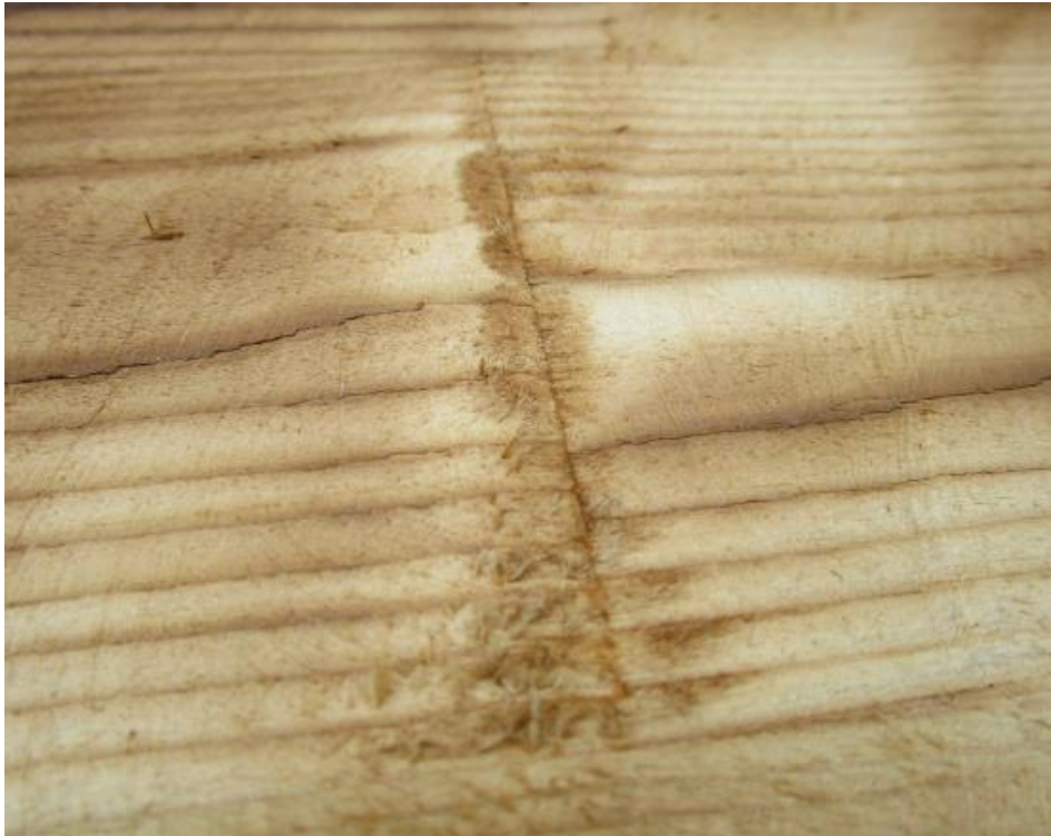
Kuva 20. Koekappale PALO 2 (Saumojen halkeamat)
