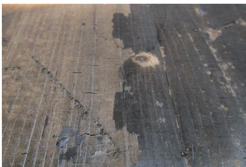
Kuva 15. Koekappale SAVU 1 (Hiiltymä 0 – 2 mm)
