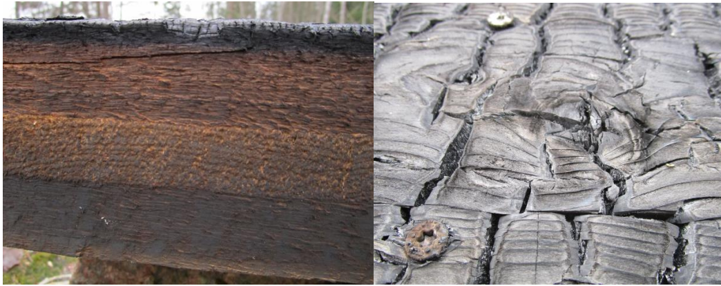
Kuva 12. Koekappale PALO 3 (hiiltymä keskellä n. 10-20 mm)
