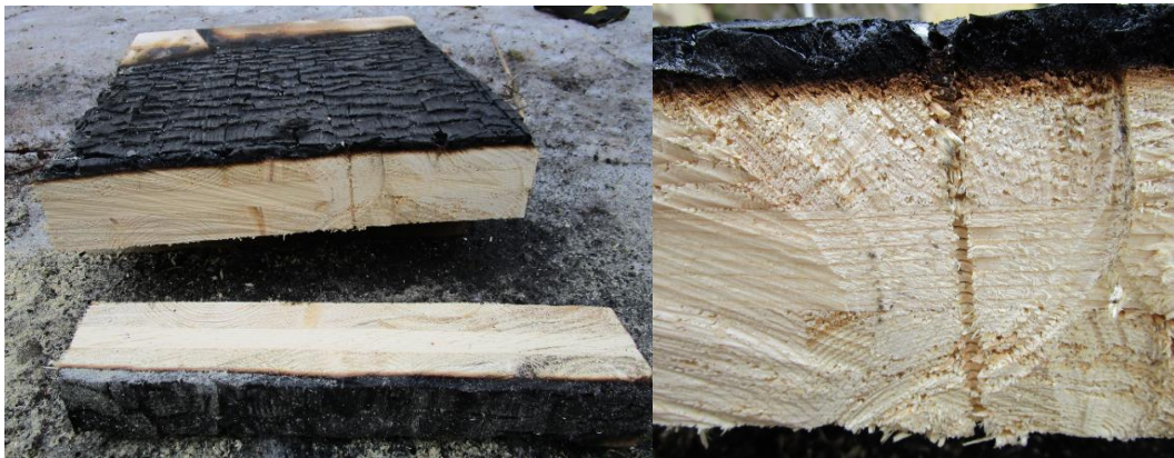
Kuva 13. Koekappale PALO 3 (Liittimen kohdan tarkastelu)
