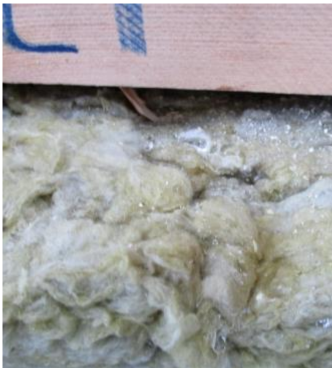
Kuva 33. Koekappale LEVY 2, kosteus villan päällä eristetilassa
