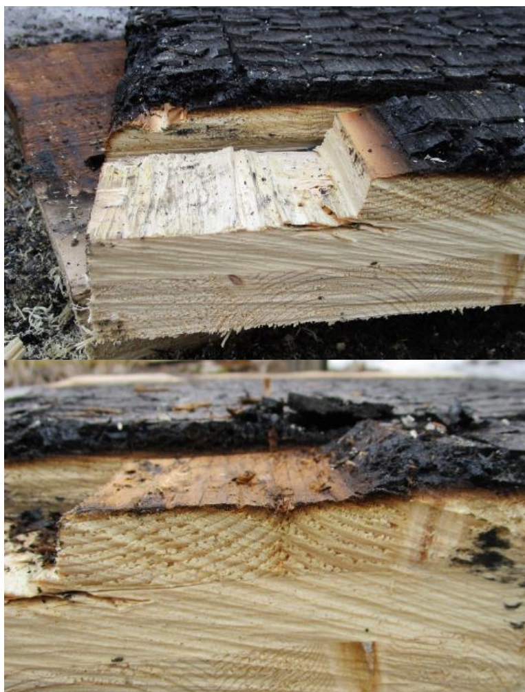
Kuva 14. Koekappale PALO 3 (Leikkeen poisto ja korjaus)
