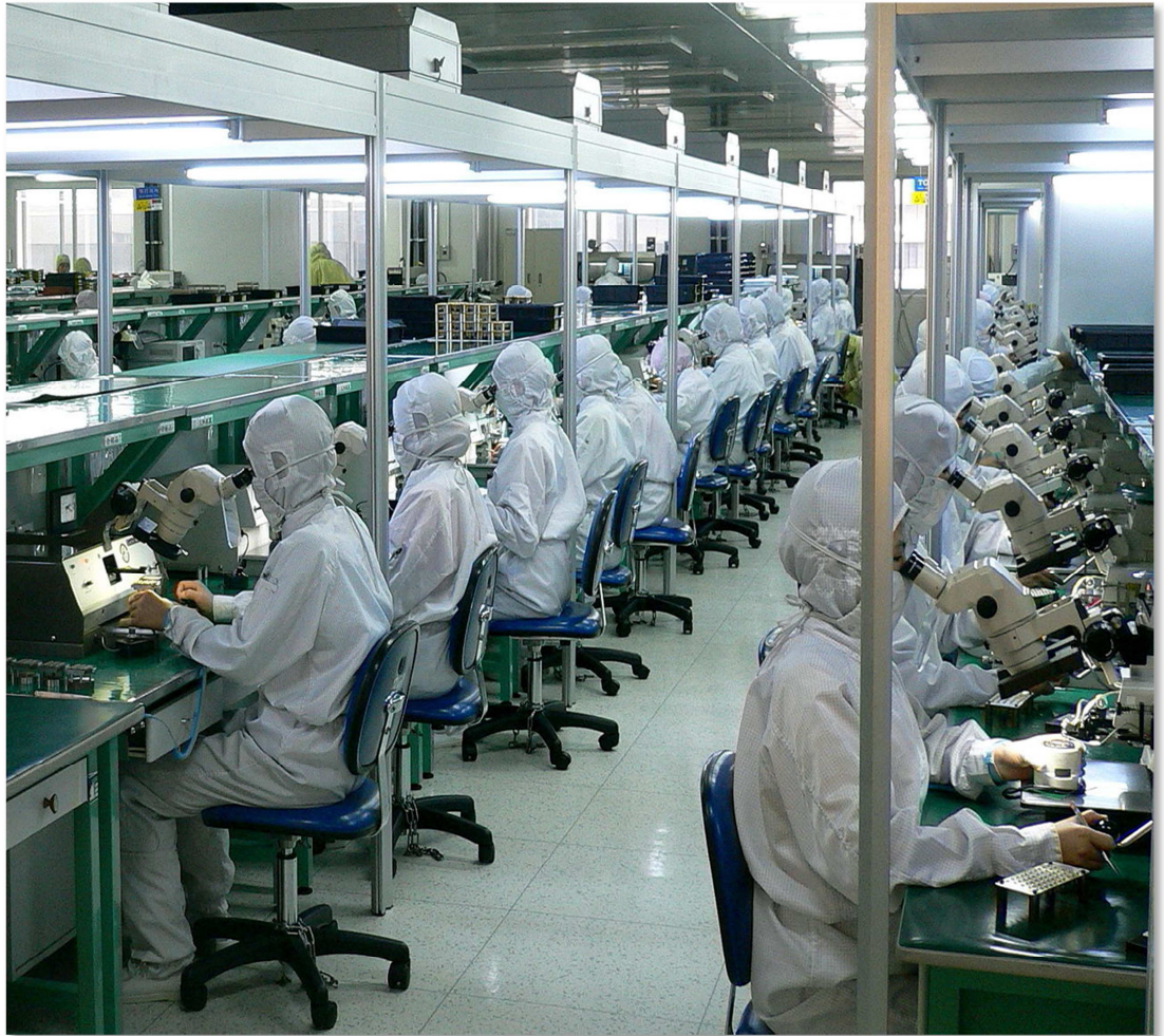
KUVA 4. Kuituoptiikan testausta puhdistilassa (Jurvetson 2006)
