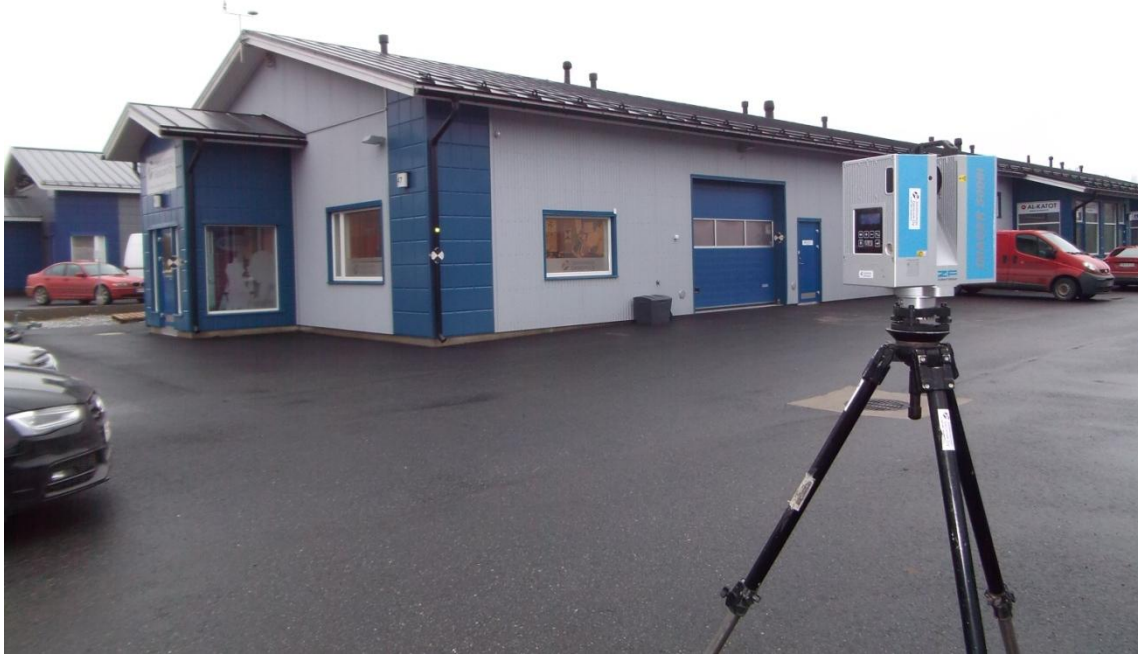
Kuva 11. Laserkeilain pystytettynä ja mittaamassa
