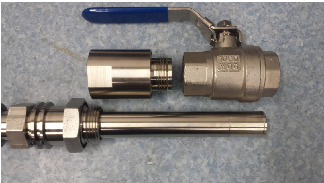
Kuva 14. Valokuva anturista, yhteen jatkeesta ja asennusyhteestä
