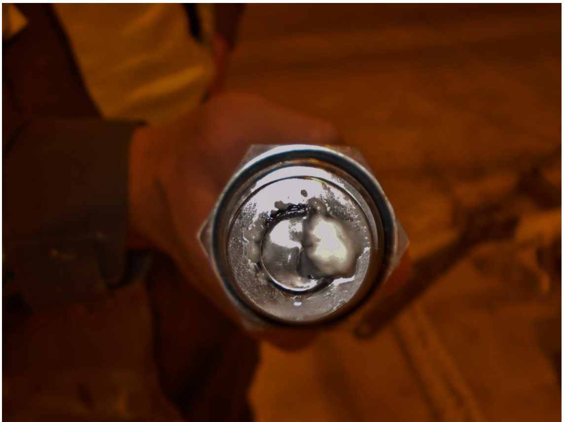
Kuva 18. Valokuva anturin mittapähän tarttuneesta massatärkkelyksestä.
