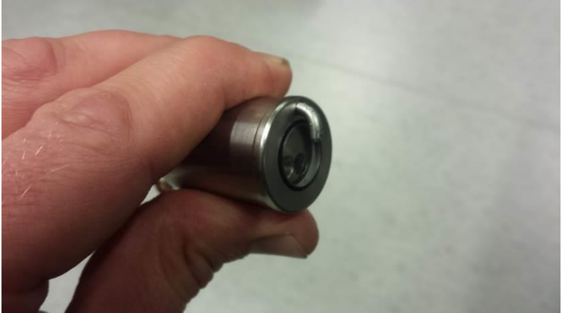
Kuva 19. Valokuva ilmapuhallussuuttimella varustetun anturin mittapästä.
