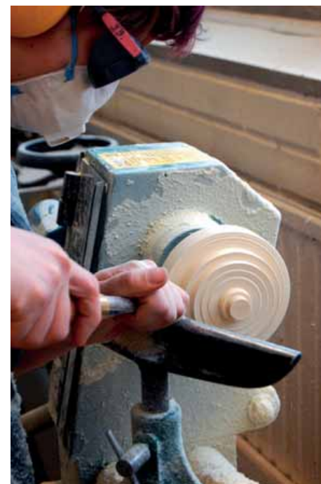
Puuttuvien rosettien tilalle valmistettiin uudet sorvaamalla
