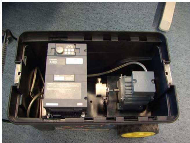
Kuva 3. Moottorin ja taajuusmuuttajan kiinnityspaikat
