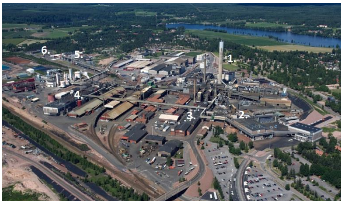
Kuva 1. NNH Suurteollisuuspuistossa, 1. Boliden sulatto, 2. Liuottamo, 3. Elektrolyysi, 4. Pelkistämö, 5. Kemikaalitehdas, 6. NNH:n konttori./15/
