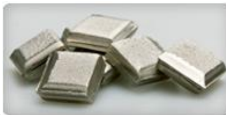
Kuva 3. Metalliset tuotteet: 1. Nikkelibriketit ja 2. nikkelikatodit./4/
