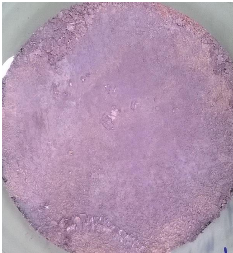
Kuva 31. Kokeen 11 suodatusvaiheessa muodostunutta kidettä, joka sisälsi 13,3 % Co, 14,7 % Ni ja 15,7 % S
