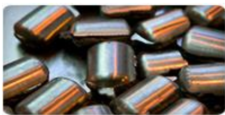
Kuva 3. Metalliset tuotteet: 1. Nikkelibriketit ja 2. nikkelikatodit./4/
