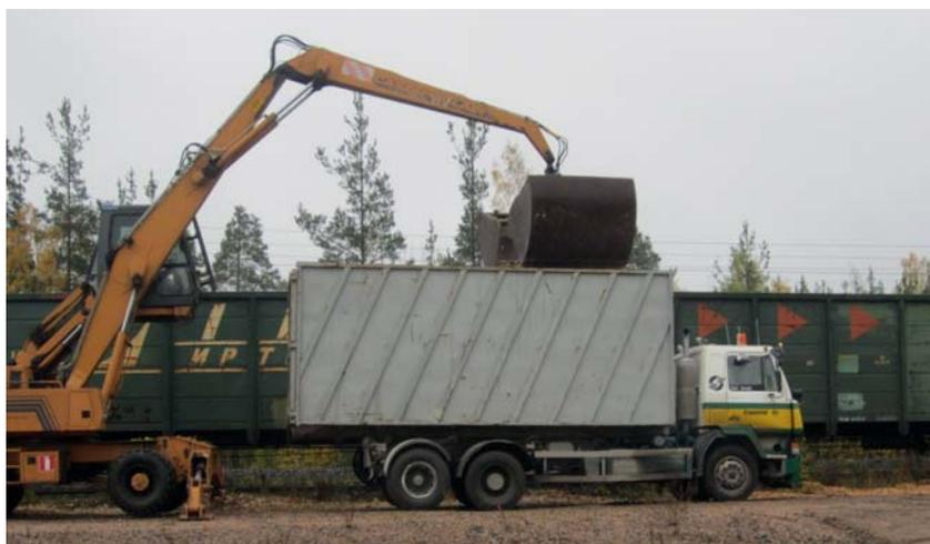
ФОТО 5. Перегрузка из железнодорожного вагона в грузовик на терминале в Курквуори, Финляндия (Лахтинен).
