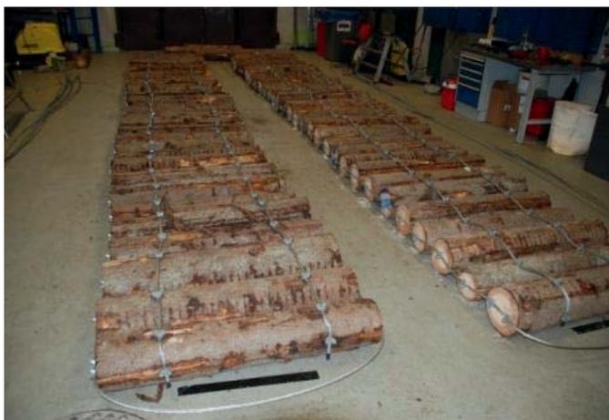
ФОТО 4. Второй протестированный деревянный мат (Suorsa 2011).
