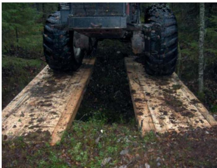
ФОТО 1. Тестируемый деревянный мост для переезда (Jääskeläinen 2009).
