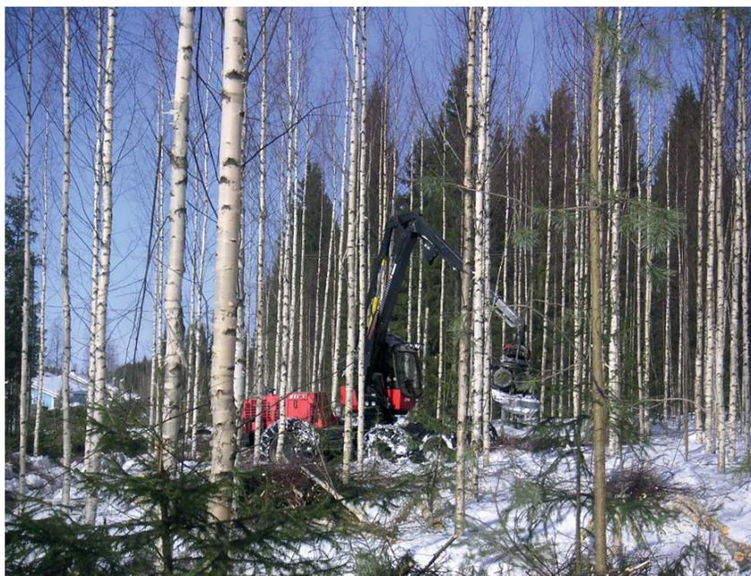
ФОТО 1. Первое прореживание в березняке с использованием среднегабаритного однозахватного харвестера (Leinonen 2010).
