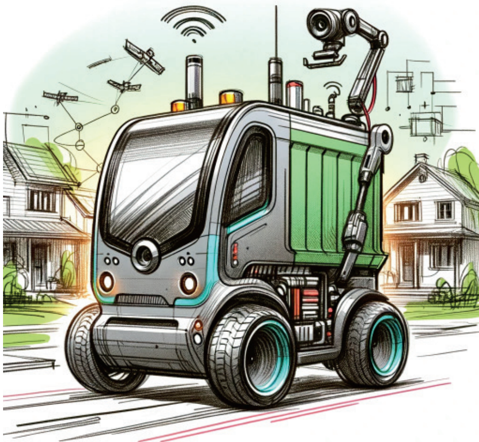
KUVIO 14. Hahmotelma pienestä täyssähköisestä jätekuljettimesta
