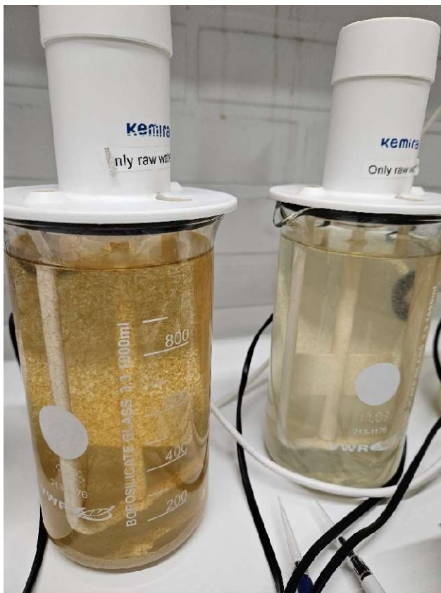
Kuva 10. Saostusprosessi flokkulaattorissa. Vasemmalla PIX (rauta) ja oikealla PAX (alumiini).
