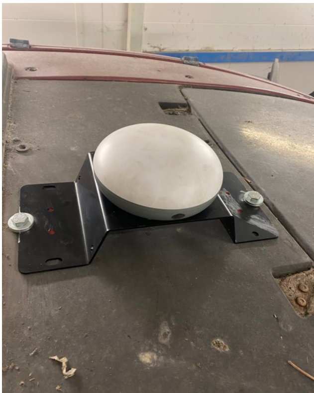
Kuva 4. GNSS-vastaanotin asennettuna katolle.
