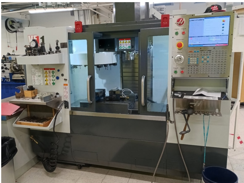
Kuva 1. Työssä käytetty HAAS VF-1 -työstökeskus.
