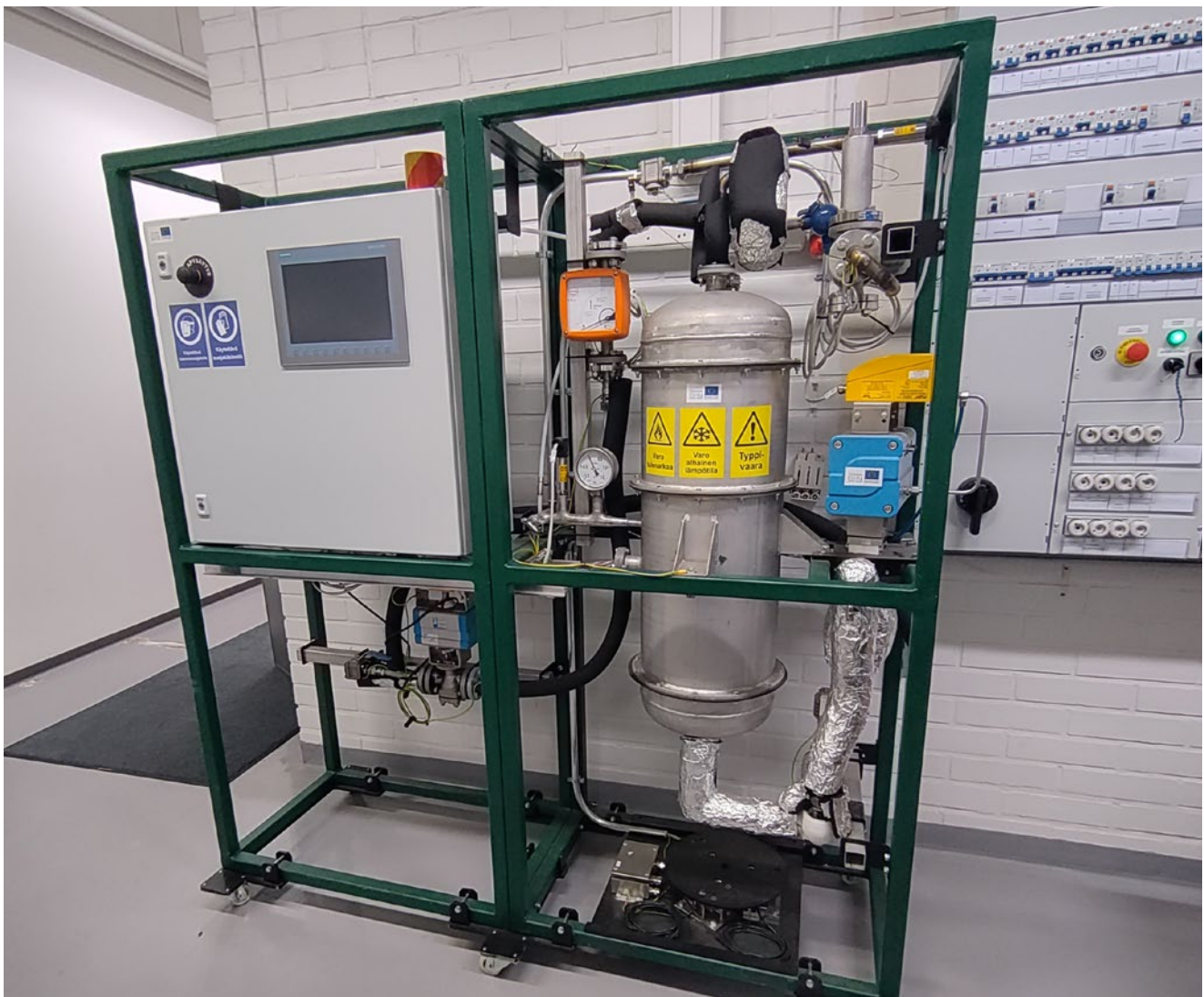
Kuva 3. Nesteytyslaitteisto Centrian laboratoriossa (Mäenpää 2024.)
