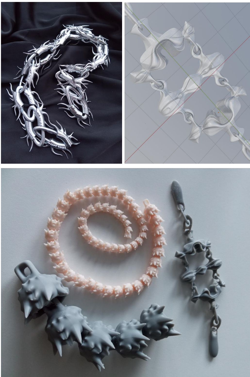
KUVA 14.–16. Rhinoceros ja 3D-tulostus. Rhinocerosella mallinnettuja ja hartsitulostimella tulostettuja nivellettyjä malleja.
