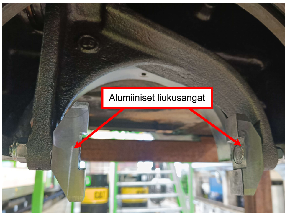
KUVA 67. Uudenmalliset alumiiniset liikusangat (Kuva: Juuso Puranen)
