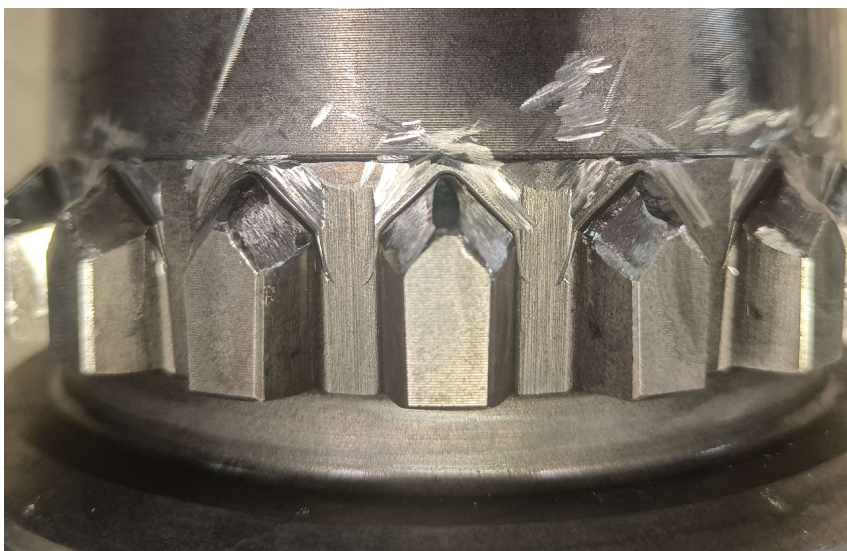
KUVA 72. Kytkentäholkin terävät hampaat (Kuva: Juuso Puranen)
