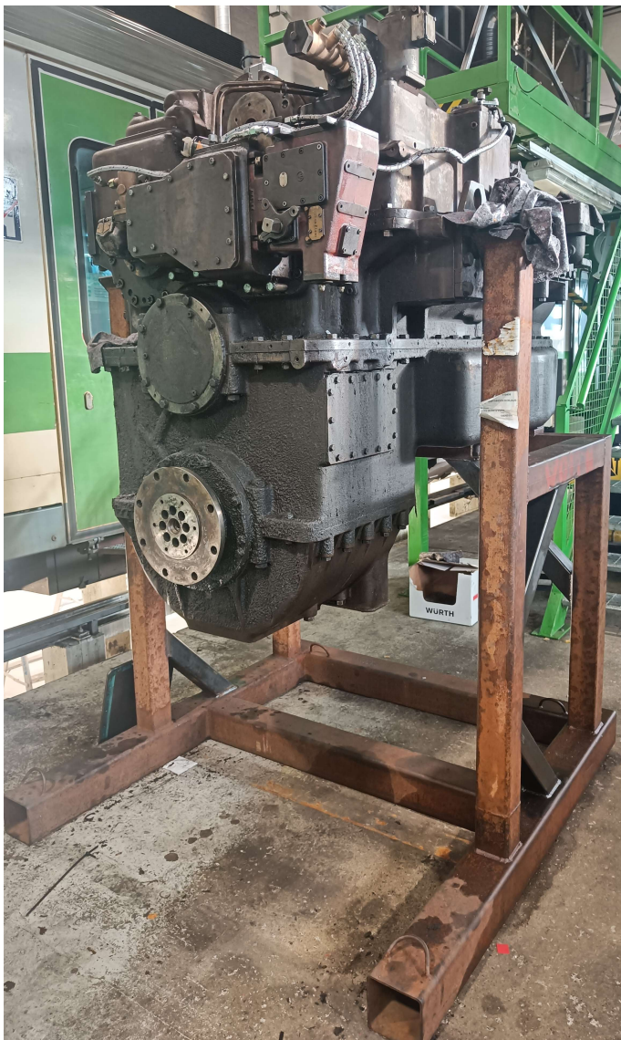
KUVA 48. Vaihteisto huoltopukilla (Kuva: Juuso Puranen)
