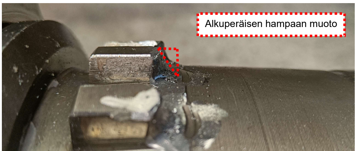
KUVA 32. Vaurioituneet holkin hampaat sivusta kuvattuna (Kuva: Juuso Puranen)
