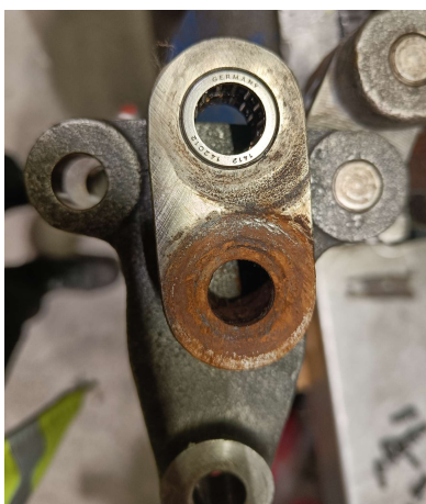
KUVA 21. Ruostunut neulalaakeri. (Kuva: Juuso Puranen)
