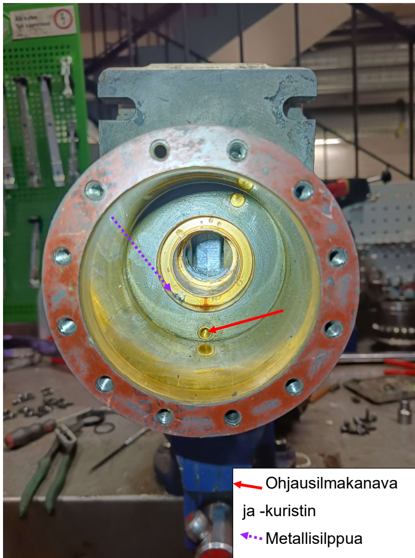
KUVA 17. Sylinteri holkkeineen ja ohjausilmakanava ja -kuristin. (Kuva: Juuso Puranen)
