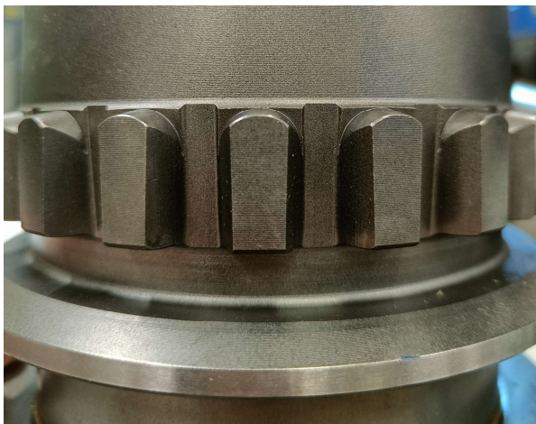
KUVA 68. Kytkentäholkin pyöreät hampaat (Kuva: Juuso Puranen)
