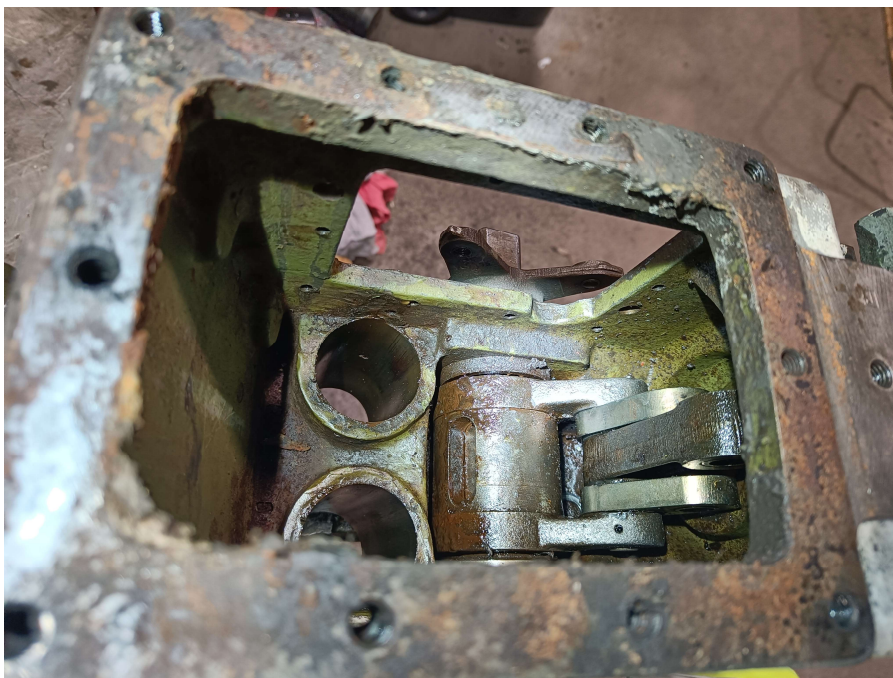
KUVA 19. Suunnanvaihtosylinterin linkustoa sylinterin sisällä. (Kuva: Juuso Puranen)
