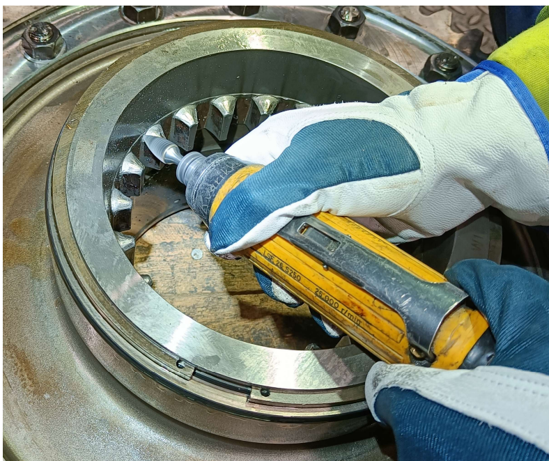
KUVA 63. Kytkentähampaiden hiontaa (Kuva: Juuso Puranen)
