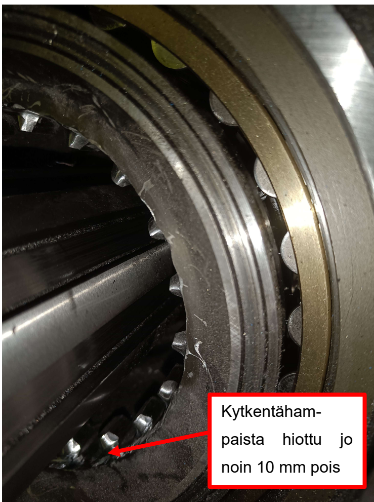
KUVA 71. Pyöristetyt napojen hampaat (Kuva: Juuso Puranen)
