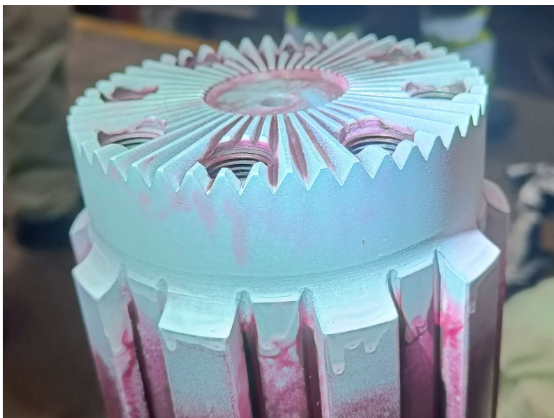
KUVA 60. Ulostuloakselin särötarkastus, ei säröjä (Kuva: Juuso Puranen)
