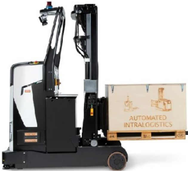
Kuva 15. Mitsubishin automaattiohjattu trukki (Mitsubishi Logisnext Europe B.V. 2024).
