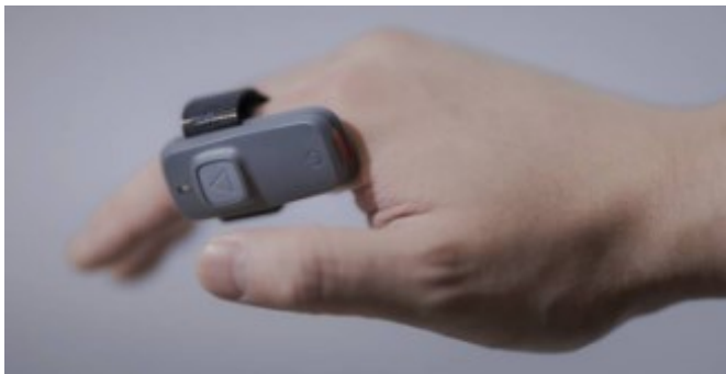
Kuva 16. Kaukosäädin keräilytukin etäohjaukseen (Toyota Material Handling Finland Oy 2022h).
