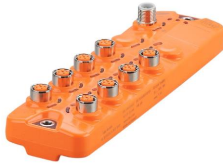
Figur 9. IO-Link modul från IFM. (ifm, 2023(b)).
