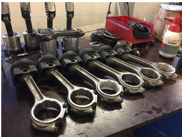
Kuva 2. Moottorin männät ja kiertokanget pöydällä ennen kasausta.
