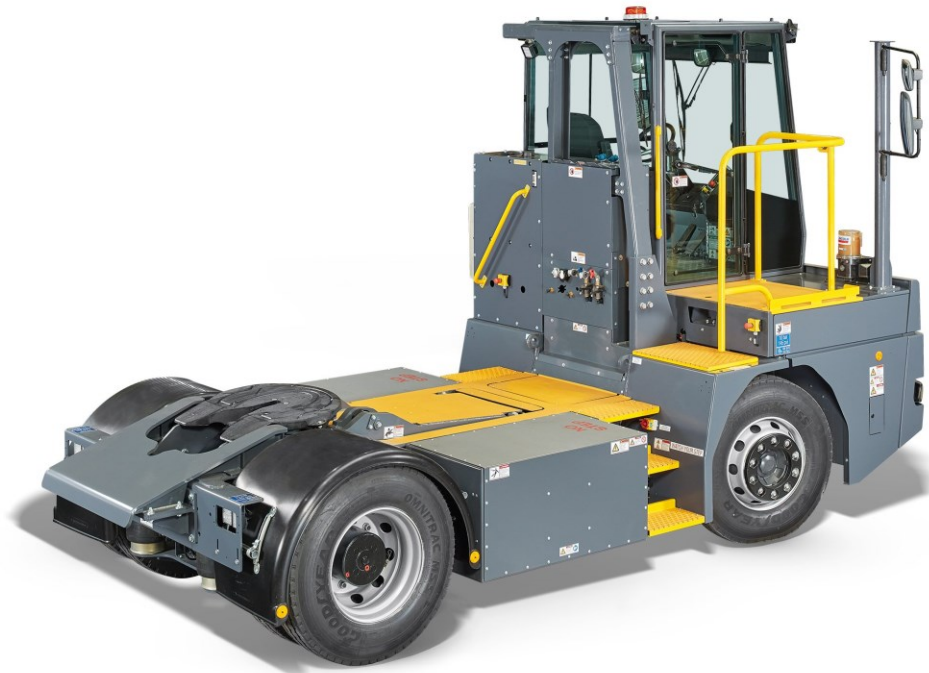
KUVA 6. Sähkökäyttöinen vetomestari (MAFI).
