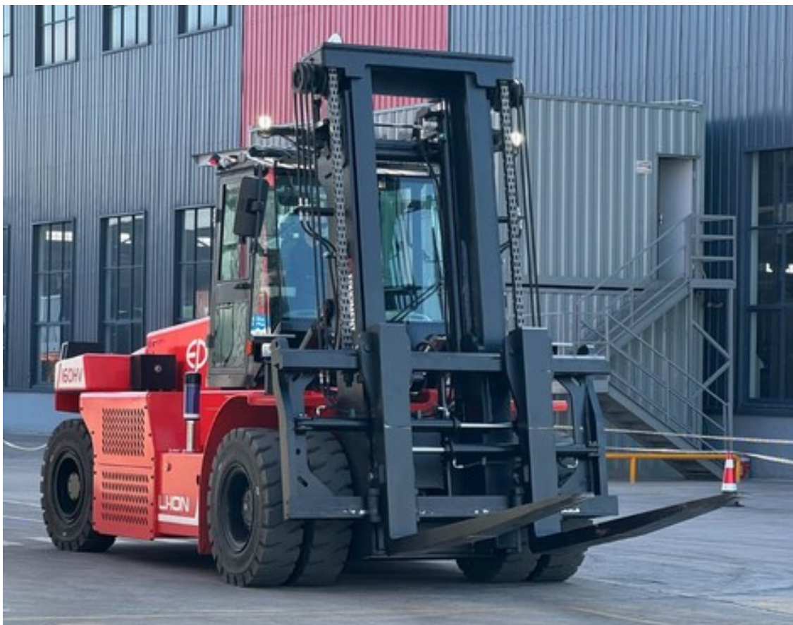
KUVA 7. Vastapainotrukki 18 tonnin kokoluokassa (Gumtree).
