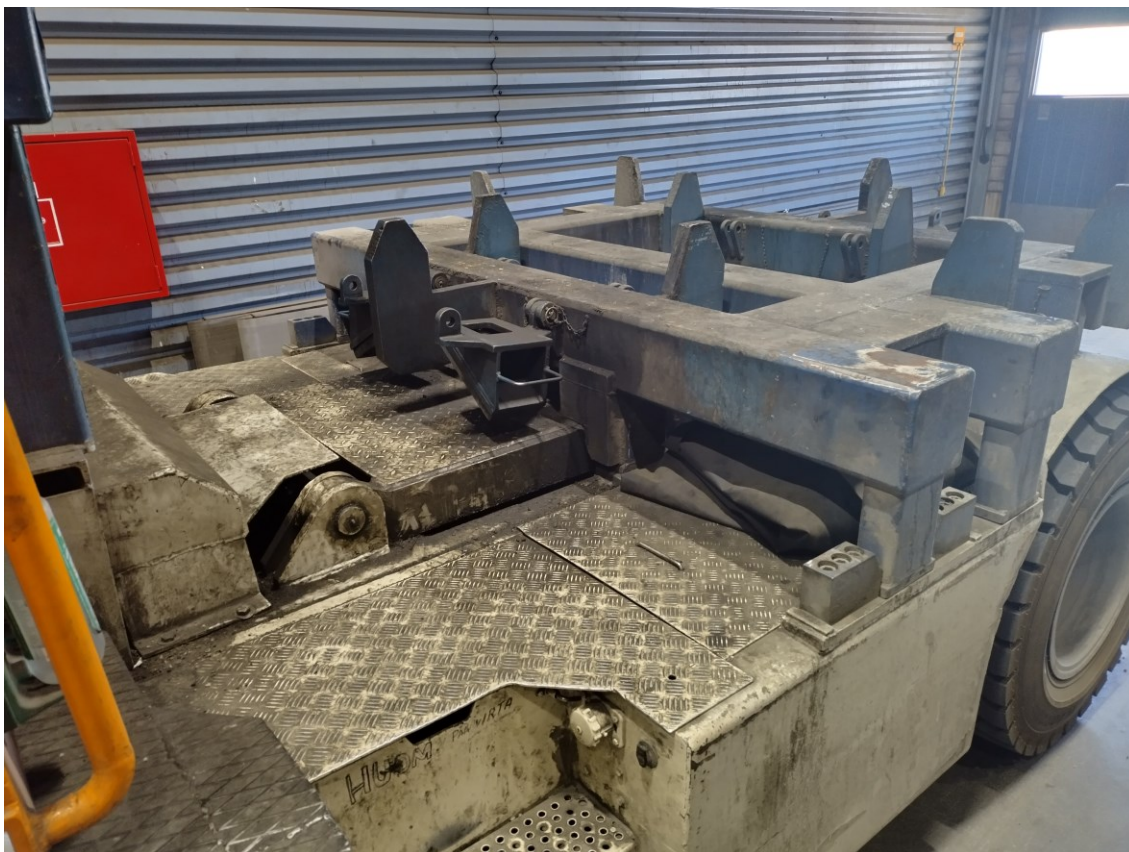
KUVA 3. Öljystä, rasvasta ja liasta liukas lavarakenne (Weeraradne, P.).
