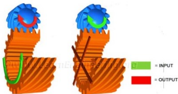
KUVA 7. Kierukkavaihde voi pyörittää kierukkapyörää (Kuva: https://www.le-sics.com/torsen-differential-how-does-it-work.html ).
