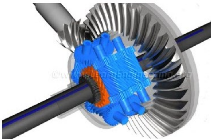
KUVA 6. Kierukkapyörät ja -vaihteet (Kuva: https://www.lesics.com/torsen-differential-how-does-it-work.html ).
