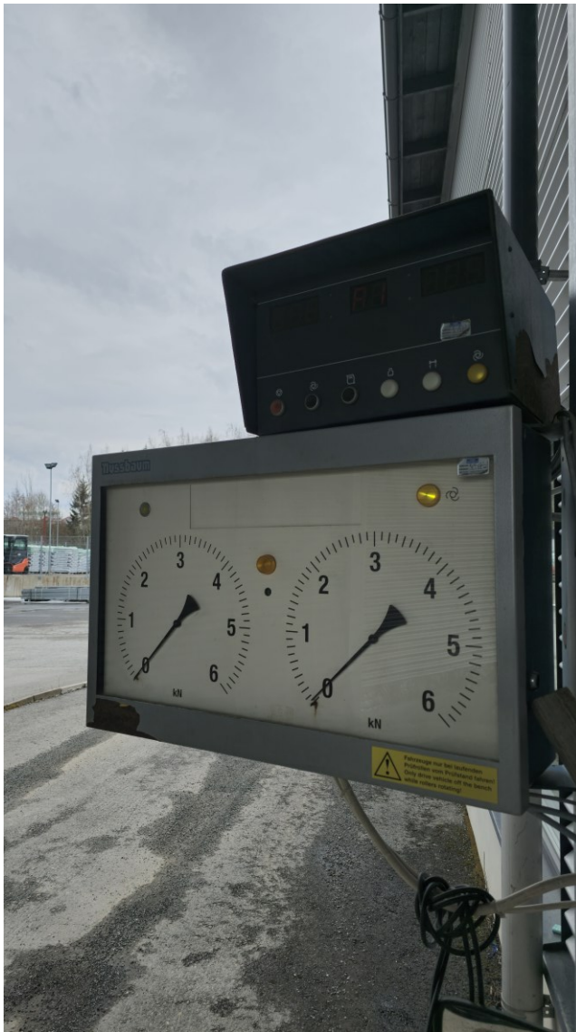
KUVA 3. Yläpuolelta nähdään iskaritulokset ja alataulusta jarruvoimat kilonewtoneina (Kuva: Juho Lähetkangas).
