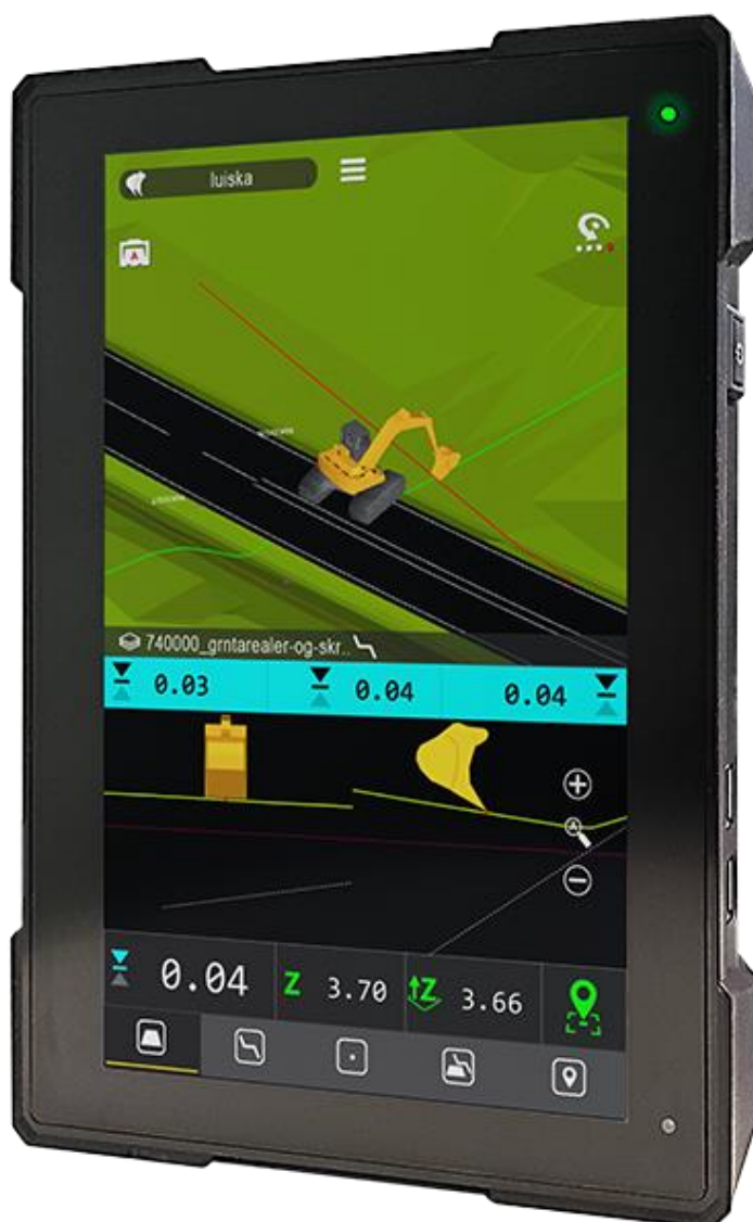
KUVA 2. Xsite® PRO 3D tarjoaa työmaakoneen kuljettajalle runsaasti tietoa koneen sijainnista suhteessa työmaasuunnitelmaan (Novatron Oy).
