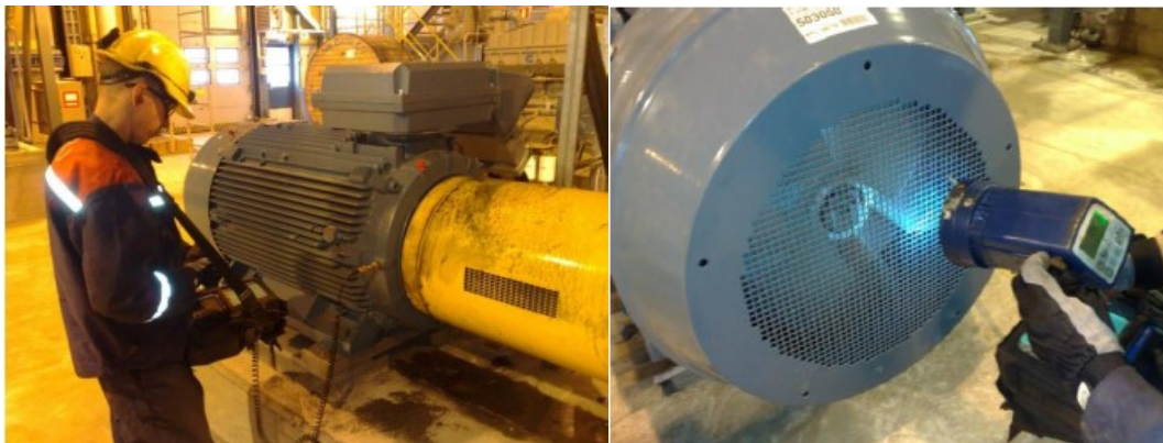
Kuvio 21. Värähtelymittausta jäähdytysvesilaitos 2:n eräällä moottorilla (Ellala 2013, 64–65)
