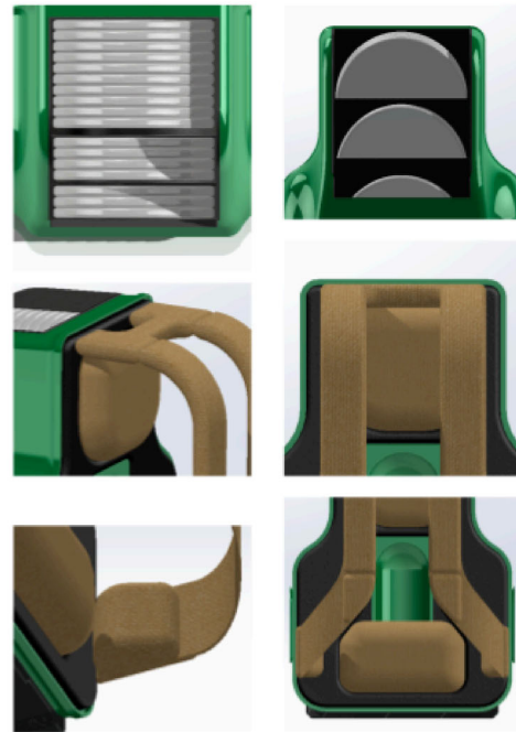
Kuva 24. CAD-kuvakollaasi repun rakenteellisista yksityiskohdista. Kiekko-osion sekä tuennallisista kantaan liittyvistä seikoista (Veikkolainen, T.)
