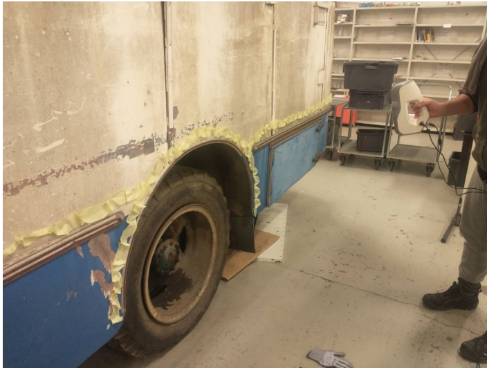
Kuva 12. Auto kyljen keilaus Artec Eva -käsiskannerilla.
