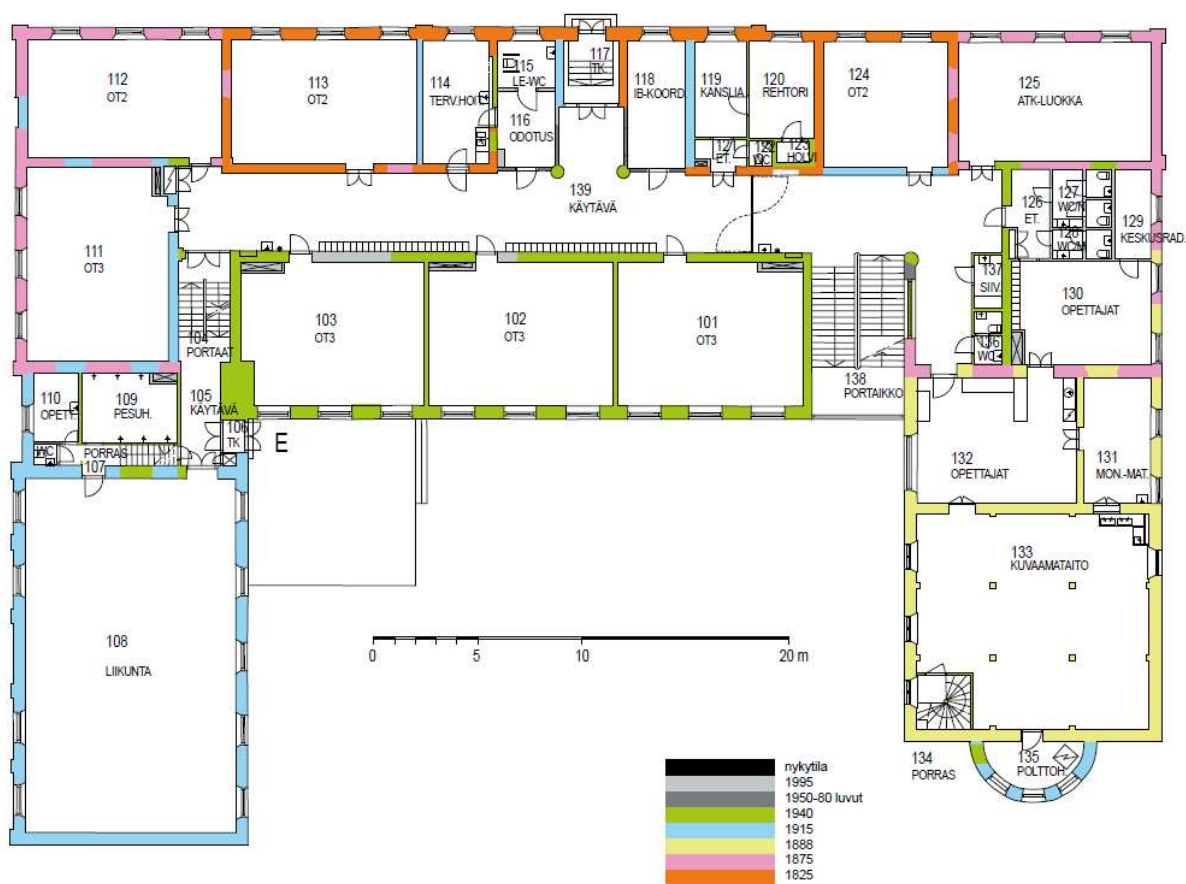
Kuva 4. Aikatasokaavio Lyseon lukion ensimmäisen kerroksen rakennusvaiheista (Puurunen 2015)
