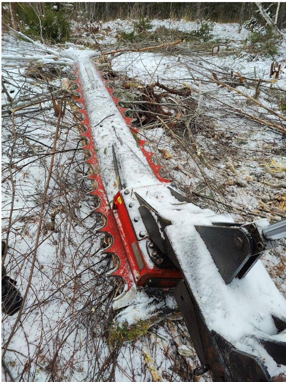
Kuva 8. Mense raivauspää, joka on muotoilultaan saman tyylinen kuin perinteinen pensasleikkuri (Jari Turtiainen 17.11.2023)
