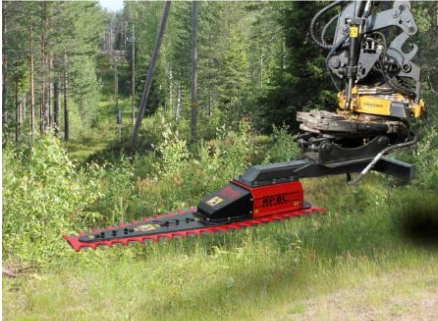
Kuva 2. Mense Raivauspää (MenSe -raivauspää sähkölinjojen tehokkaaseen ja turvalliseen raivaukseen 9.10.2014).
