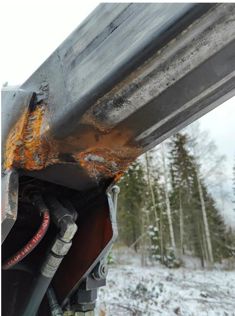
Kuva 7. Rasitus ja hitsauksen tarve maastossa (Jari Turtiainen 17.11.2023)
