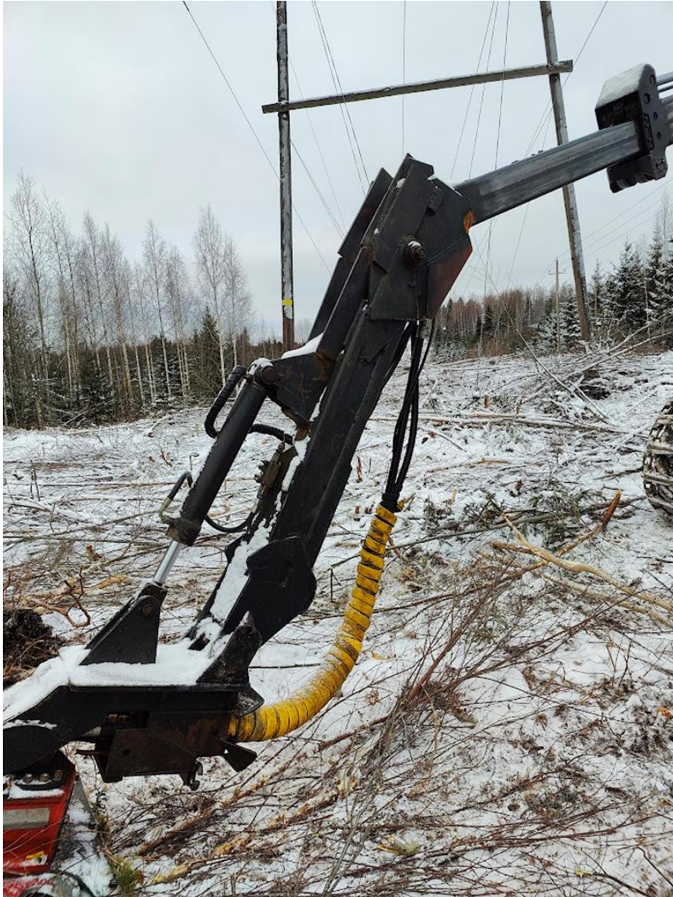
Kuva 6. Puomiin rakennettu lisäosa, johon raivauspää tulee kiinni. (Jari Turtiainen 17.11.2023)
