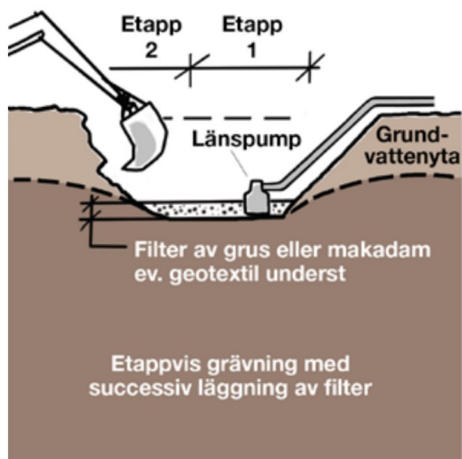
Figur 3 Schaktning med filter i silt. (SGI – Schakta Säkert, 2024)
