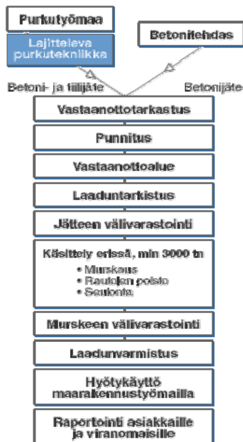
Kuva 22. Betonijätteen jalostaminen uusiotuotteeksi /13/
