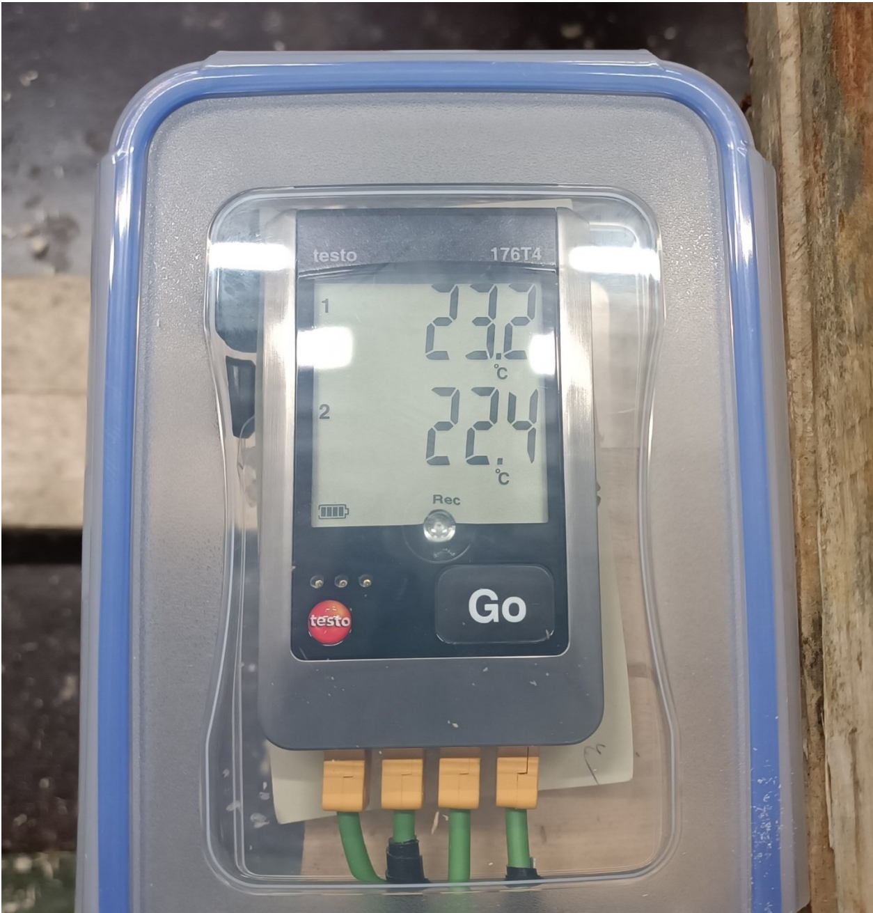
Kuva 2. Nelikanavainen datalogger Testo 716T4 suojarasiassa (Lakso, 2024).
