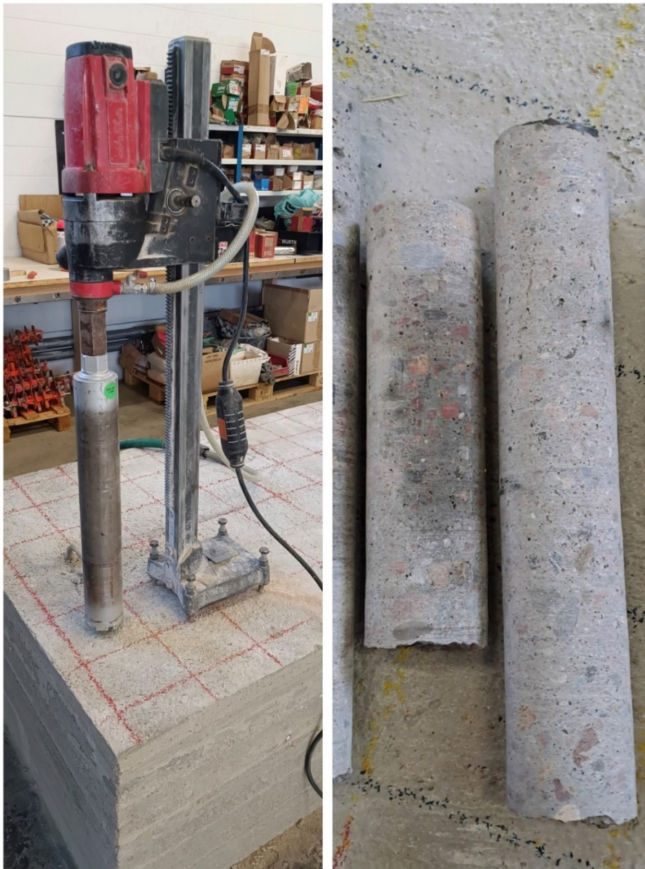
Kuva 7. Rakennekoekappaleen poraus (Lakso, 2024).
