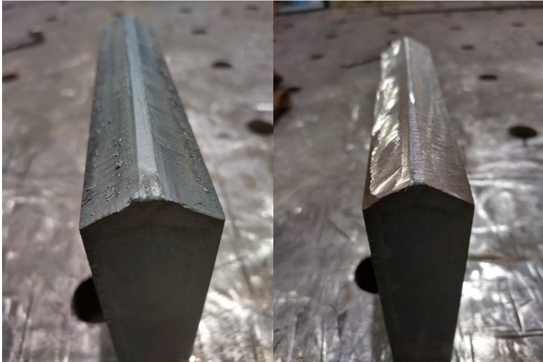
Kuva 29. Polttoleikattu railo puhdistetaan hiomalla.
