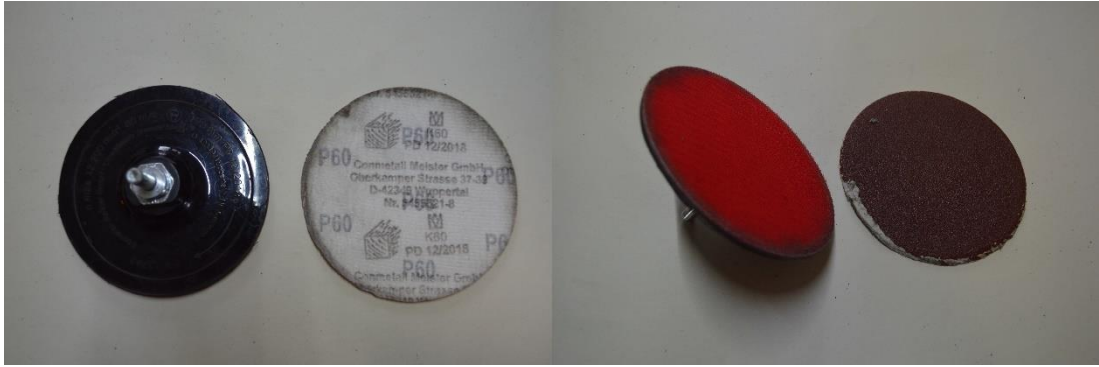
Kuva 20. Tarrakiinnityksellä varustettu hioma-alusta sekä siihen kiinnitettävä käytetty hiomapyörö.
