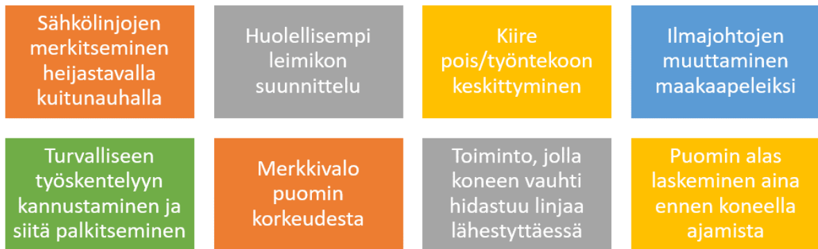
Kuva 13. Tapoja, joilla voitaisiin estää/vähentää puomi ylhäällä ajamista linjan läheisyydessä
