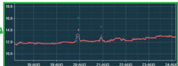
Kuva 1. Esimerkki jatkuvatoimisen vedenlaatudatan hyödyntämisestä pilottikohteessa. Kuvassa näkyy runkojohdon sulkemisesta johtuvan väripiikin eteneminen verkostossa. Huomaa piikin pieni korkeus normaaliin vaihteluun verrattuna.
