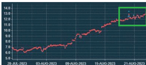
Kuva 1. Esimerkki jatkuvatoimisen vedenlaatudatan hyödyntämisestä pilottikohteessa. Kuvassa näkyy runkojohdon sulkemisesta johtuvan väripiikin eteneminen verkostossa. Huomaa piikin pieni korkeus normaaliin vaihteluun verrattuna.
