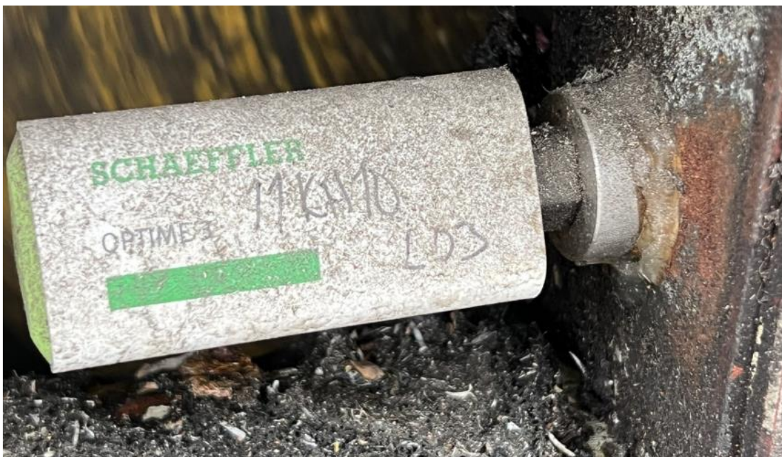
KUVA 4. Liimaamalla kiinnitetty Schaeffler OPTIME -anturi
