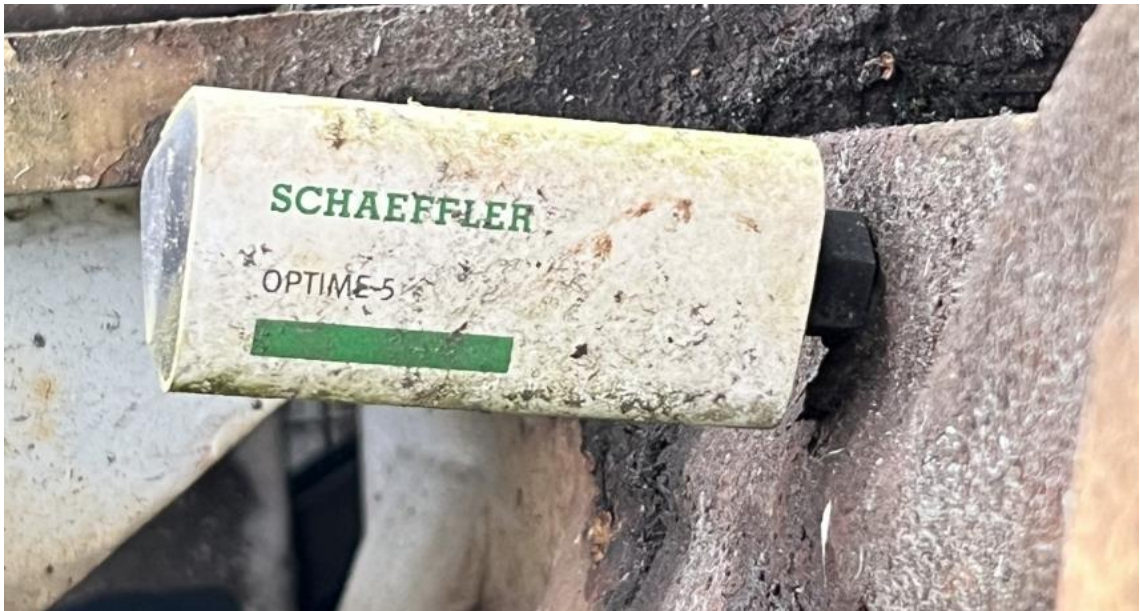
KUVA 3. Poraamalla kiinnitetty Schaeffler OPTIME -anturi
