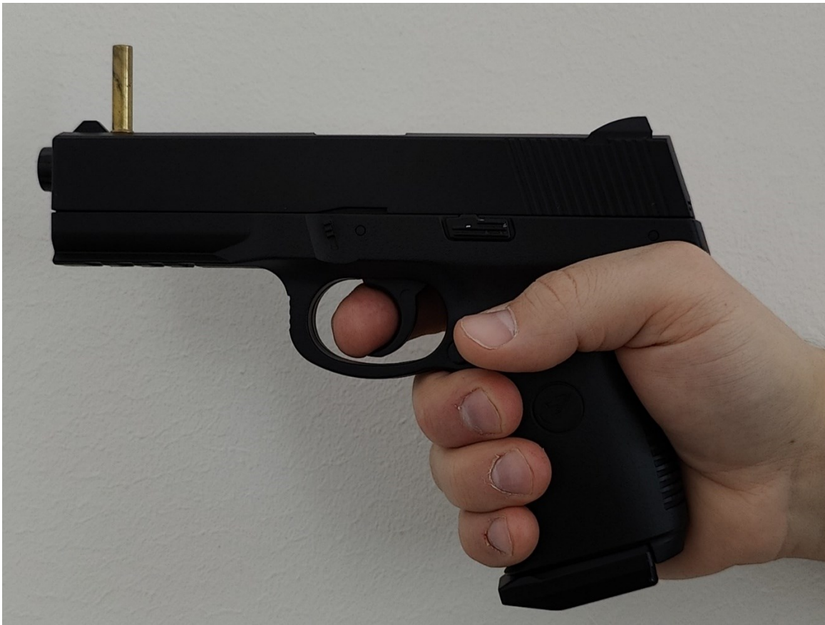
Kuva 11: Pienempi ja keveämpi hylsy paljastaa pienimmänkin heilahduksen laukaisutapah- tumassa (Opinnäytetyön tekijöiden ottama kuva).
