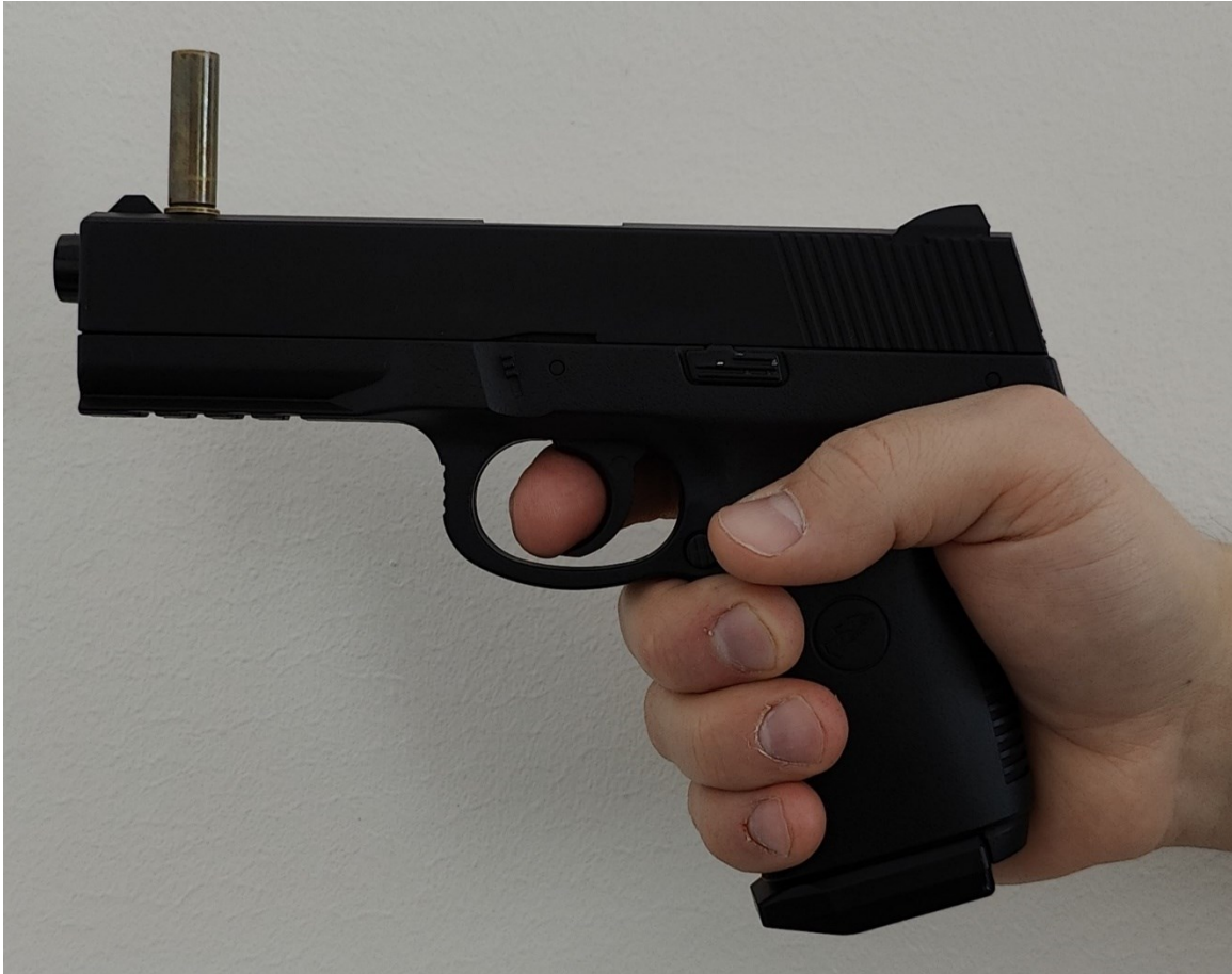
Kuva 10: Hylsy asetettu piipun päähän havainnollistamaan liikahtaako ase laukaistessa (Opinnäytetyön tekijöiden ottama kuva).
