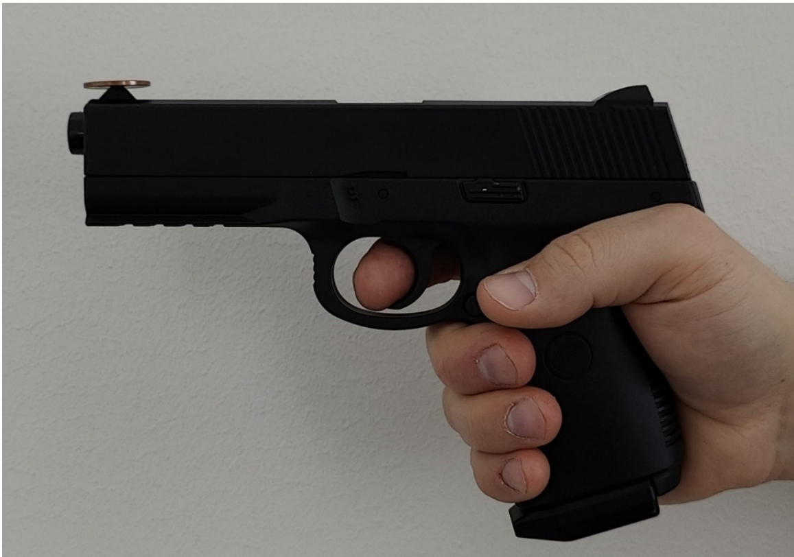
Kuva 11: Pienempi ja keveämpi hylsy paljastaa pienimmänkin heilahduksen laukaisutapah- tumassa (Opinnäytetyön tekijöiden ottama kuva).
