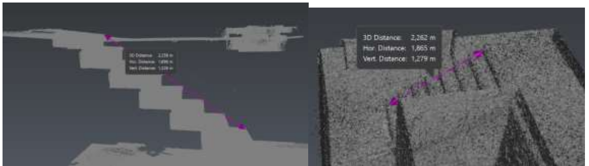
KUVA 14. Portaiden mittatarkkuuden vertailu BLK360-pistepilven ja ZEB Horizon -pistepilven mittauksen välillä. (Joel 30.04.2024)
