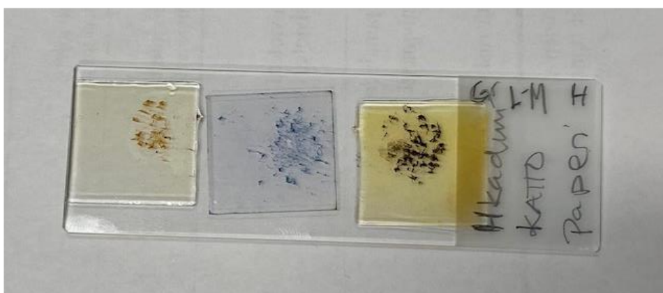
Kuva 13. Värjäysreagenssitestin tulos kattopaperin kuiduista (Viitaniemi, 2024).
