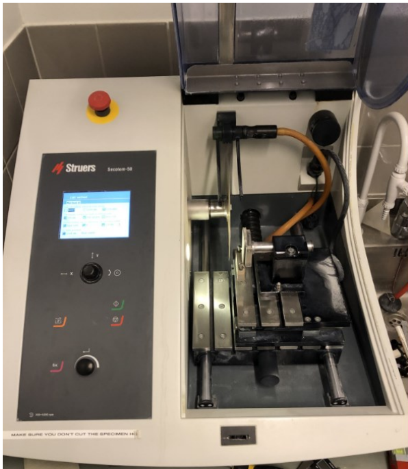
Kuva 9. Struers secotom-50 testikappalesaha
