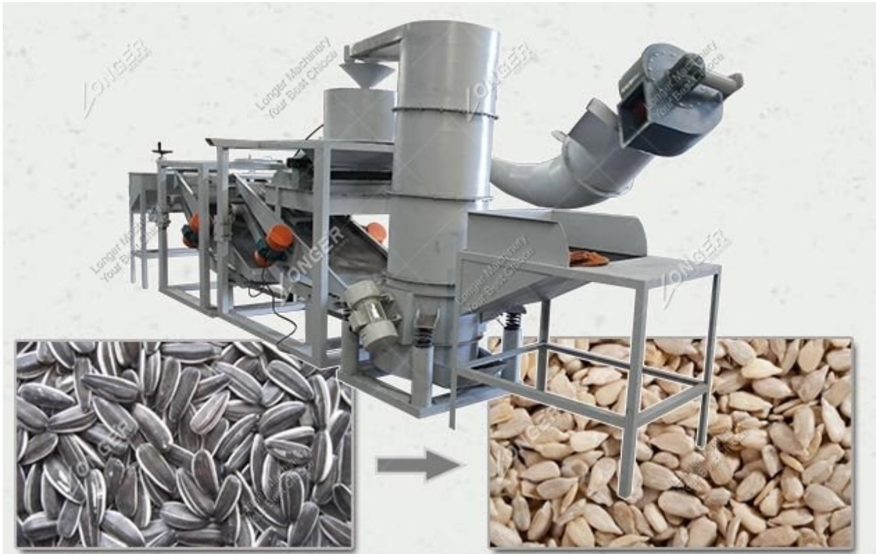
Kuva 1. Auringonkukan siementen kuorintakone (Nut machines, i.a.).
