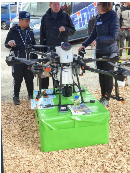
KUVA 9. Boorilannoitukseen tarkoitettu drooni FinnMETKO messuilla 2022.
