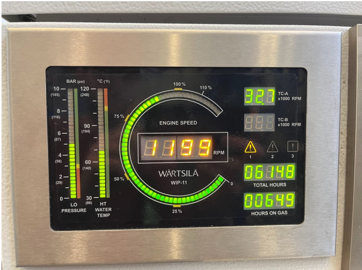
Figur 25. Motorn i körande tillstånd vid 1200 RPM på WIP-panelen.
