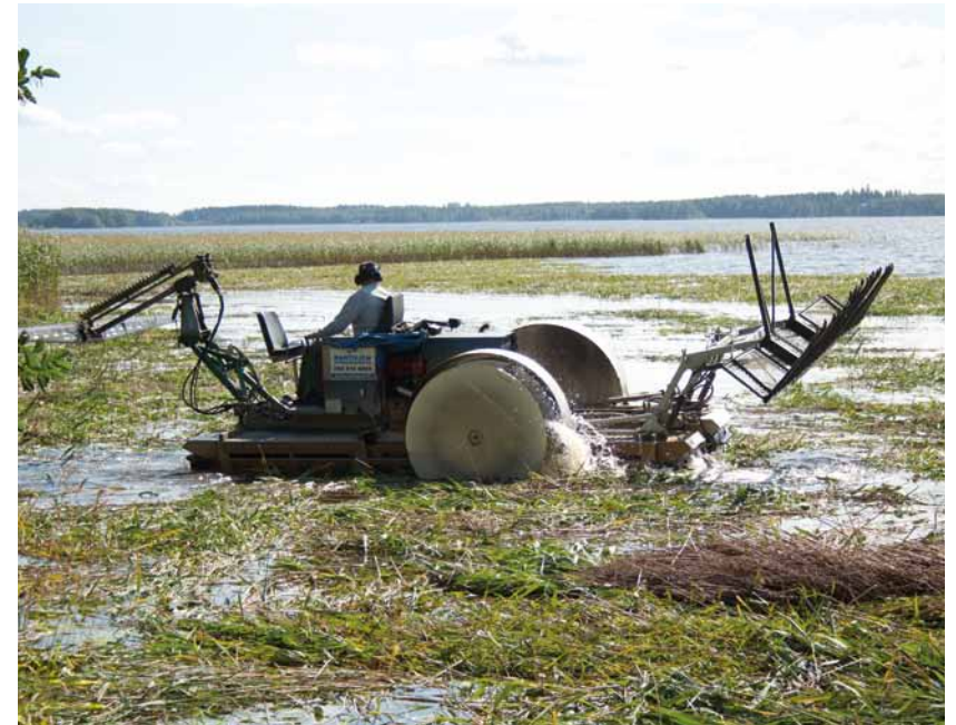
Kuva 2. Ponttoonialustainen niitto- ja keruukone, jossa edessä leikkuri ja takana keruulaite. Tässä kyseisessä koneessa on tela-alusta sekä siipirattaat. Kuva: Kaija Saramäki
