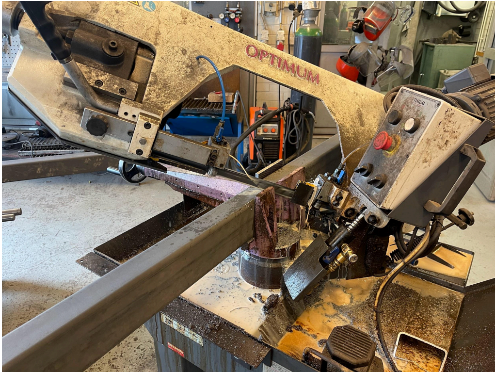
Figur 32. Sågar upp stålprofilen till ramen.
