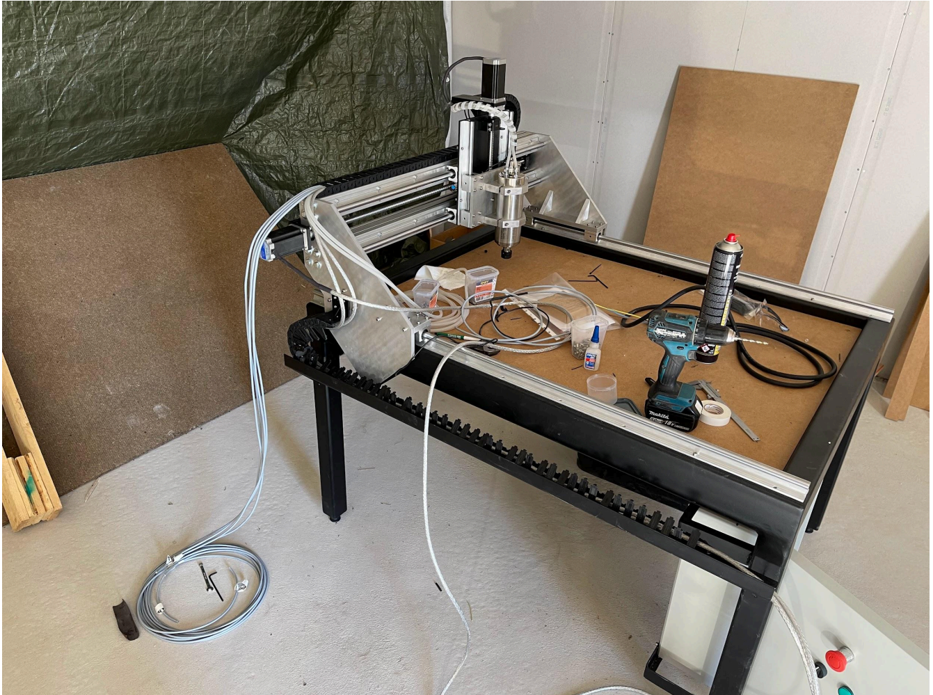
Figur 49. Överbyggnad och spindelmotor monterad.
