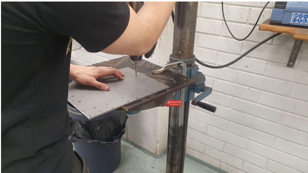
Figur 38. Tillverkning av bakplattan till z-axeln.
