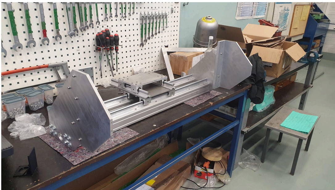
Figur 44. Provmontering av överbyggnad
