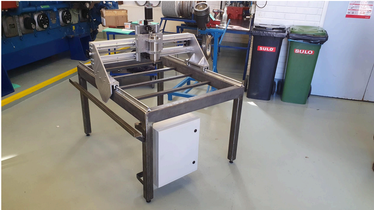
Figur 45. Testmontering av alla mekaniska komponenter innan målning.
