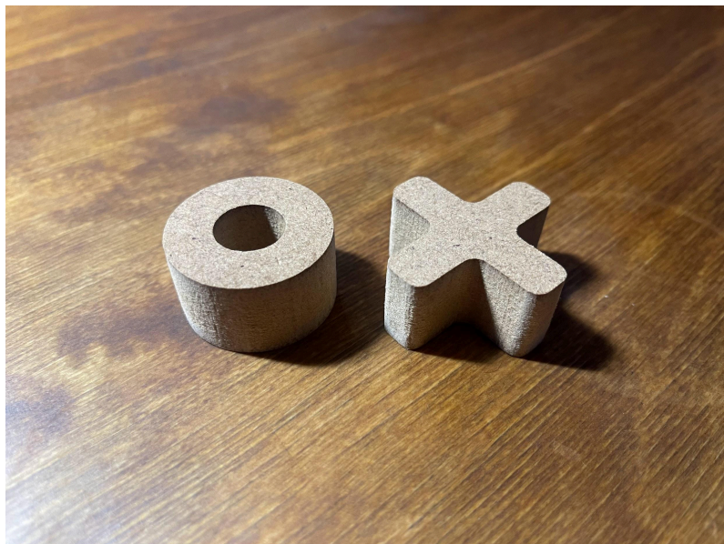
Figur 89. Slipat bort de små hörnen på bitarna efter fräsningen.
