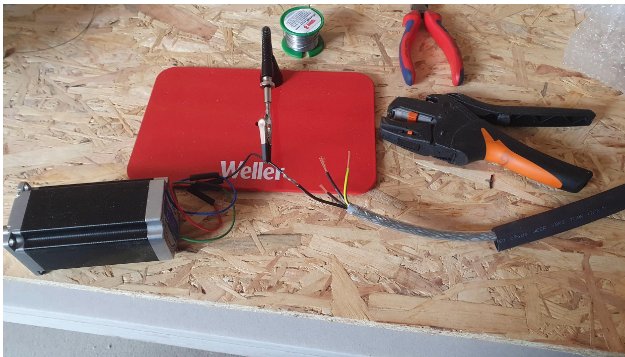
Figur 58. Lödning av kablar till stegmotorerna.
