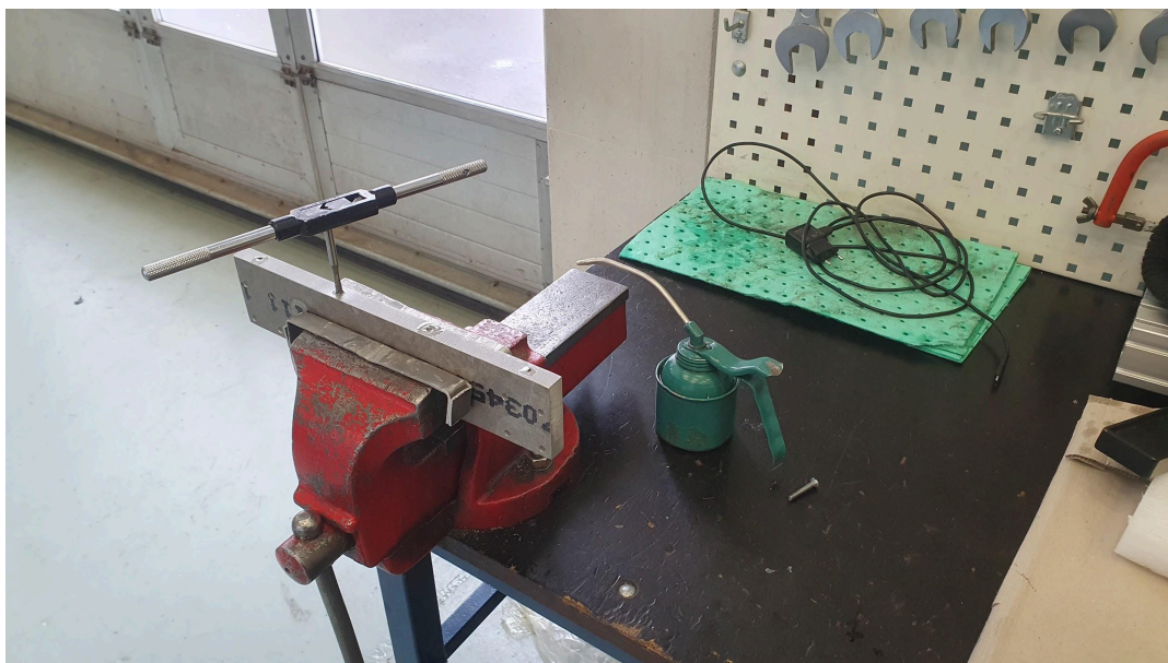
Figur 42. Borring och gängning för montering av överbyggnad.
