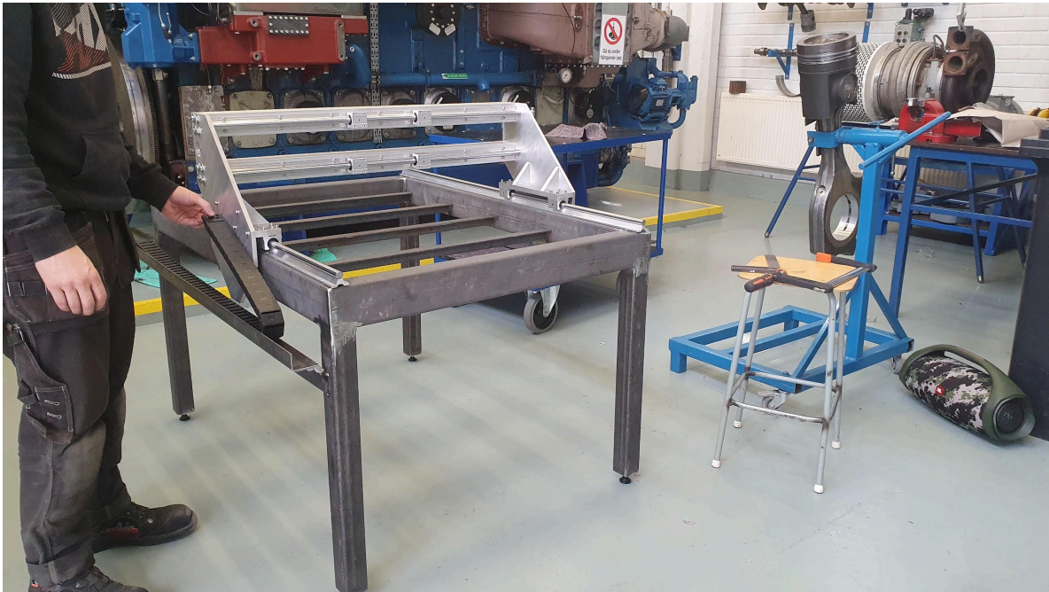
Figur 37. Testar den rörliga kabelkanalen.
