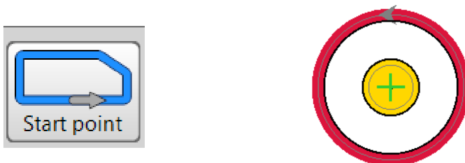
Figur 68. Använder "Start point" för att välja var fräsen ska börja.
