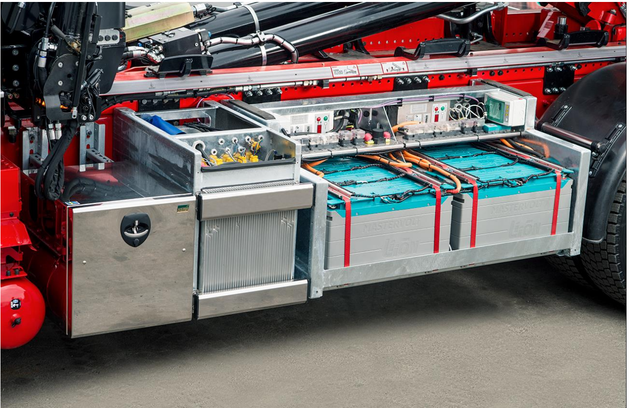
Kuvio 4. Havainnekuva kuorma-auton runkoon sijoitetusta sähköisen voimanulosoton akustosta. (ePTO n.d.)
