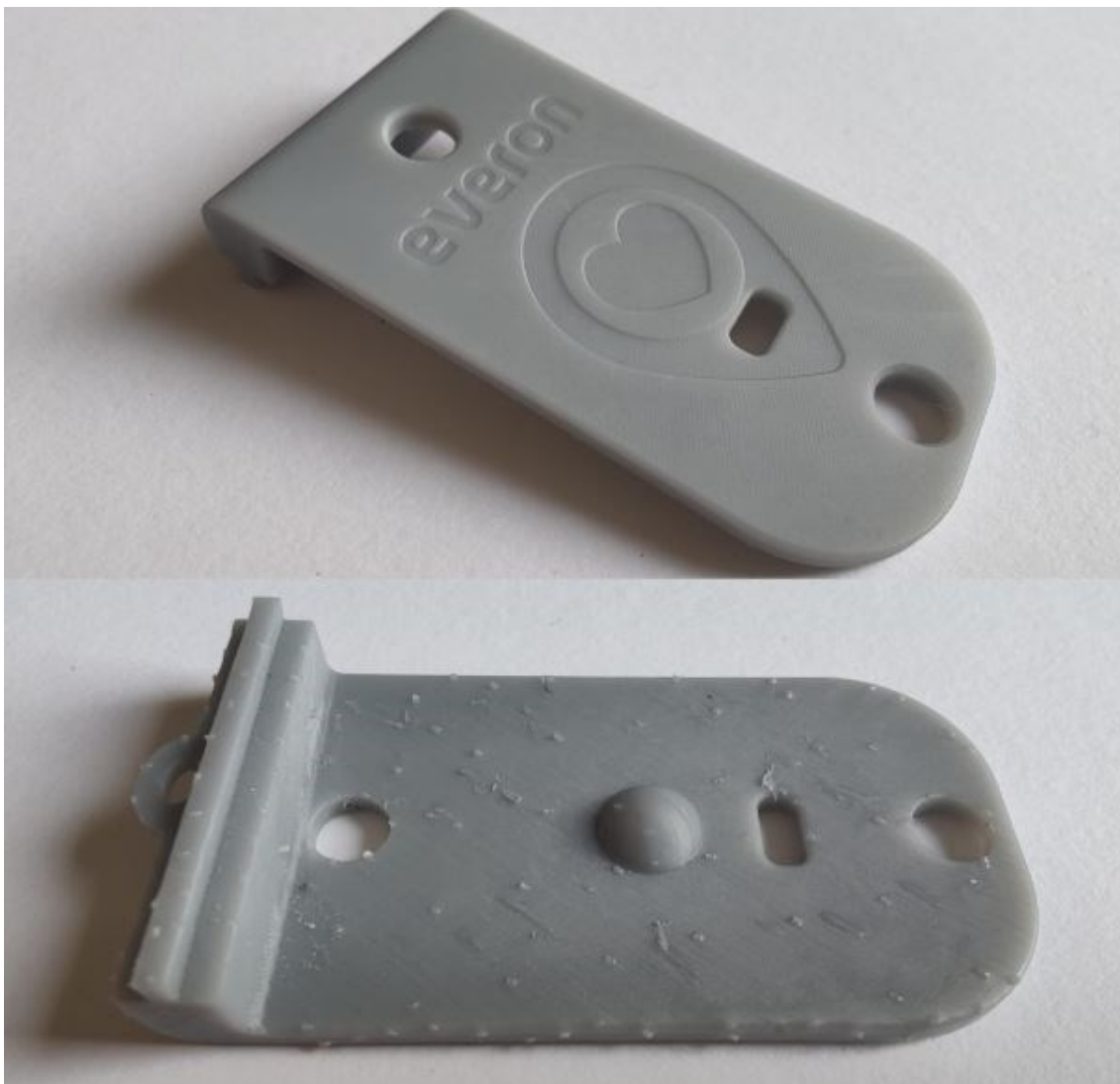
Kuva 15 Nestetulostimella valmistettu testikappale.
